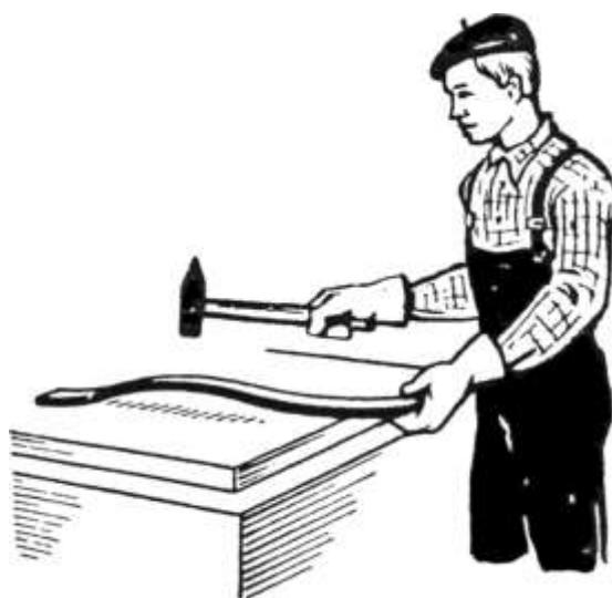
Рисунок 13 – Правка коротких прутков на плите
