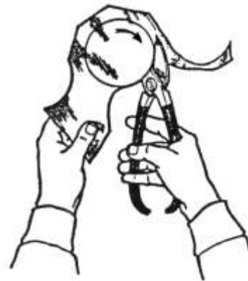
Рисунок 24 – Резка листового металла на рычажных ножницах
