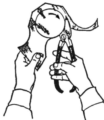
Рисунок 24 – Резка листового металла на рычажных ножницах
