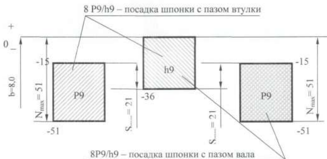
Рисунок 80 - Схема полей допусков шпоночного соединения
