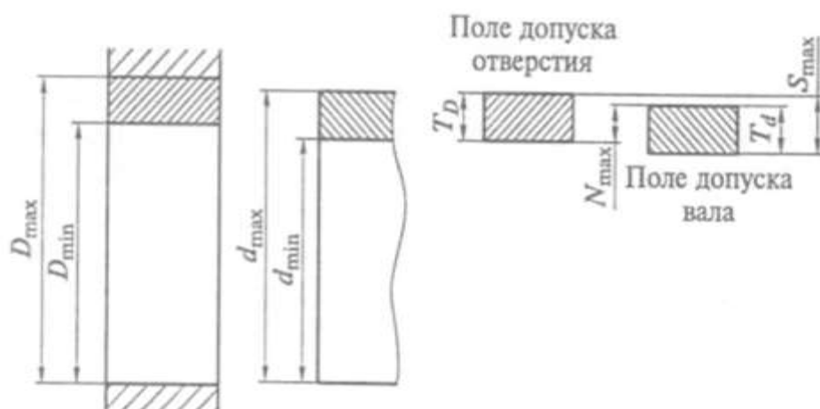
Рисунок 13 – Схемы расположения полей допусков при переходных посадках
