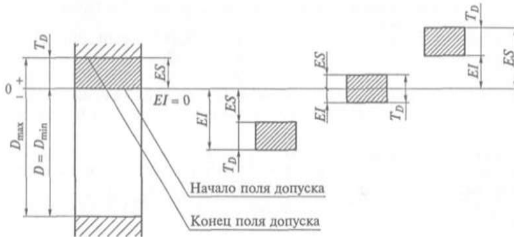
Рисунок 9 – Схема расположения полей допусков отверстий
