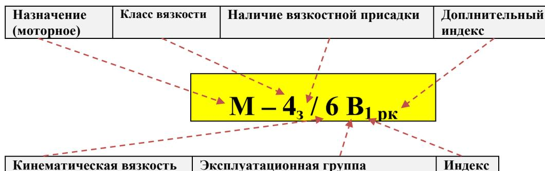
Рисунок 3.4 – Маркировка моторного масла
