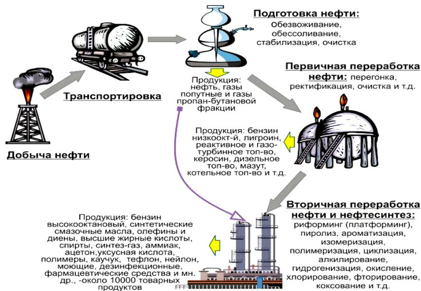
Рисунок 1.1 – Схема получения нефтепродуктов из нефти
