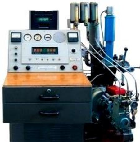
Рисунок 2.9 – Установка ИДТ-90 для определения цетанового числа дизельных топлив
