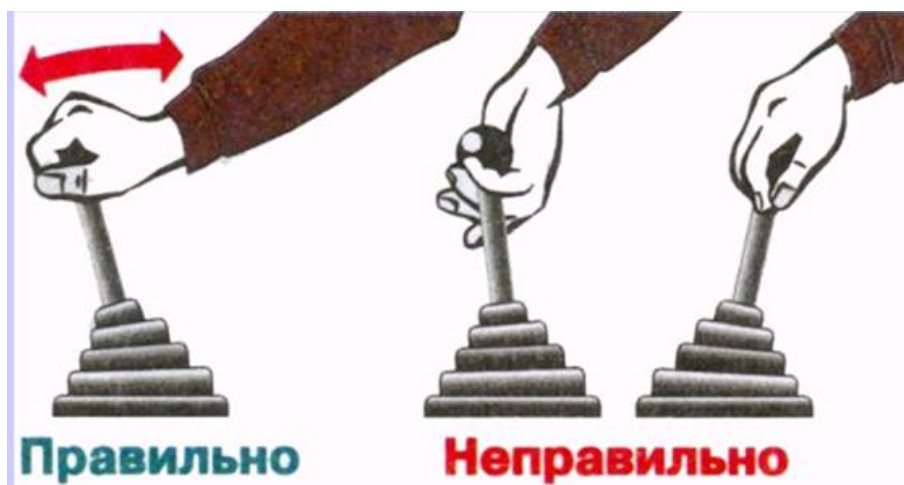
Рисунок 8. Положение кисти рук при переключении передач
