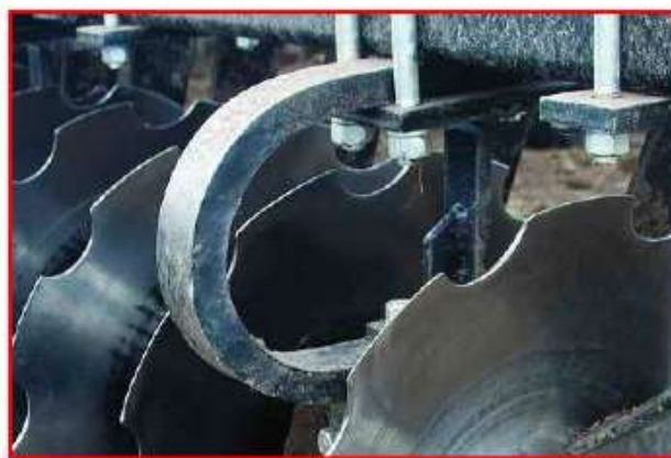
Рисунок 26– Особенности конструкции опорных кронштейнов дисковых борон
