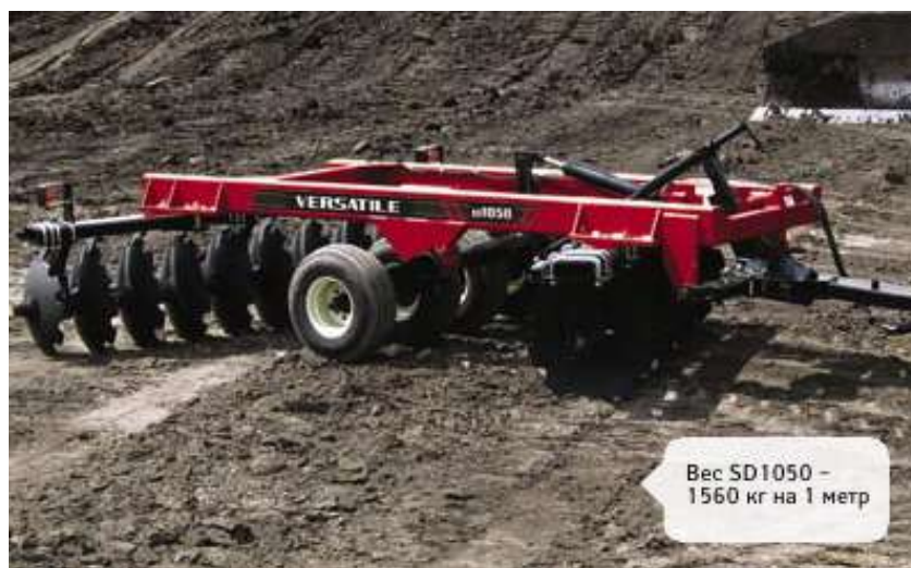
Рисунок 13– Офсетная дисковая борона SD1050
