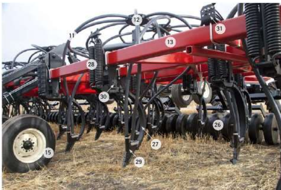
Рисунок 74 - Рабочие органы сеялки DH 750
