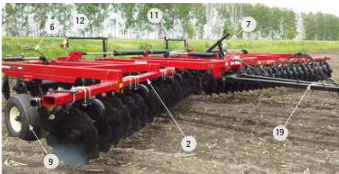
Рисунок 17 - Дисковая борона TD600
