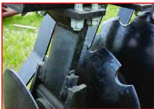
Рисунок 26– Особенности конструкции опорных кронштейнов дисковых борон
