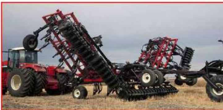
Рисунок 79 – Самоустанавливающиеся колеса сеялок DH
