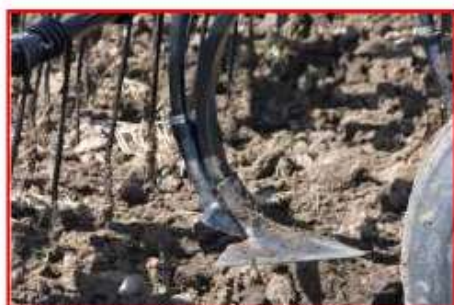
Рисунок 83 – Рабочие органы для посева DH730, 750 и C500
