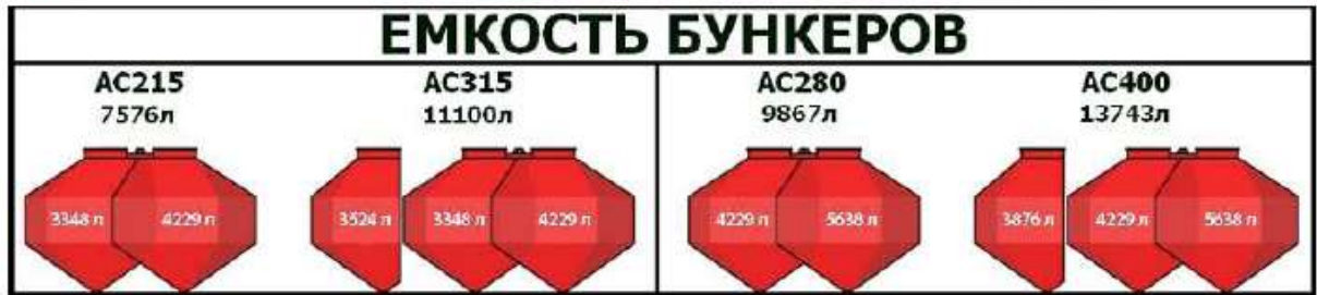
Рисунок 120 – емкость бункеров-раздатчиков серии АС
