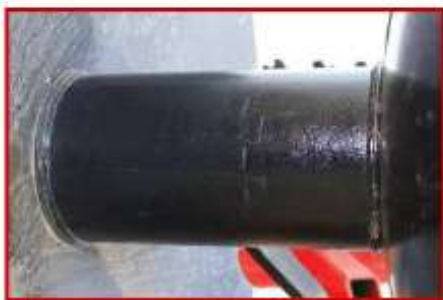
Рисунок 29– Особенности конструкции проставок (шпυлек) для дисков
