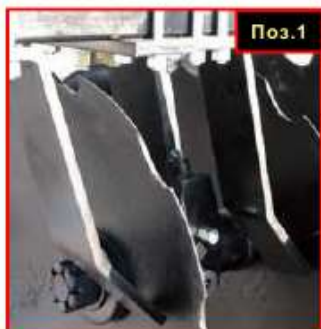
Рисунок 30– Особенности конструкции скребков дисков
