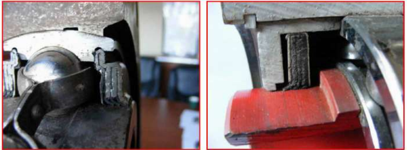
Рисунок 23 – Особенности конструкции подшипниковых узлов - максимальная защита (WSS – WideSuperSeal)
