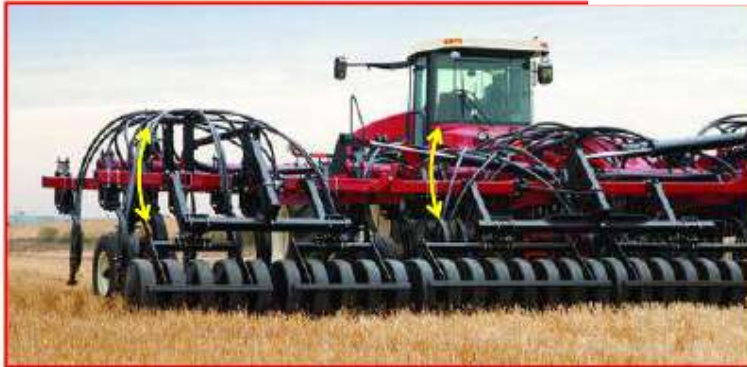
Рисунок 78 – Копирование рельефа сеялками DH
