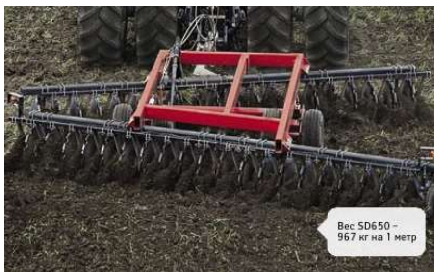
Рисунок 12– Офсетная дисковая борона SD650
