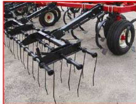
Рисунок 37- Навесное оборудование дисковых борон
