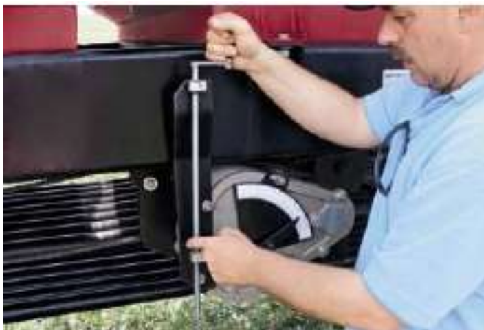
Рисунок 138 - Zero-Max с ручной регулировкой нормы высева
