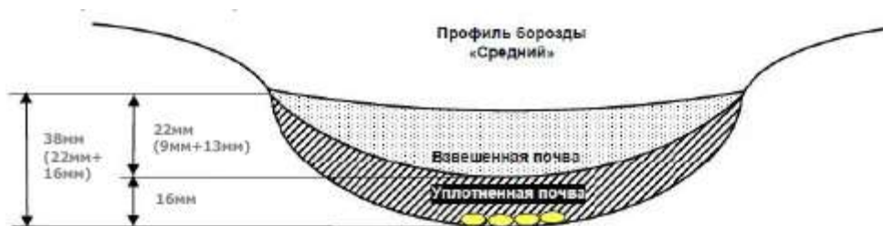
Рисунок 118 – Пример настройки заделки семян
