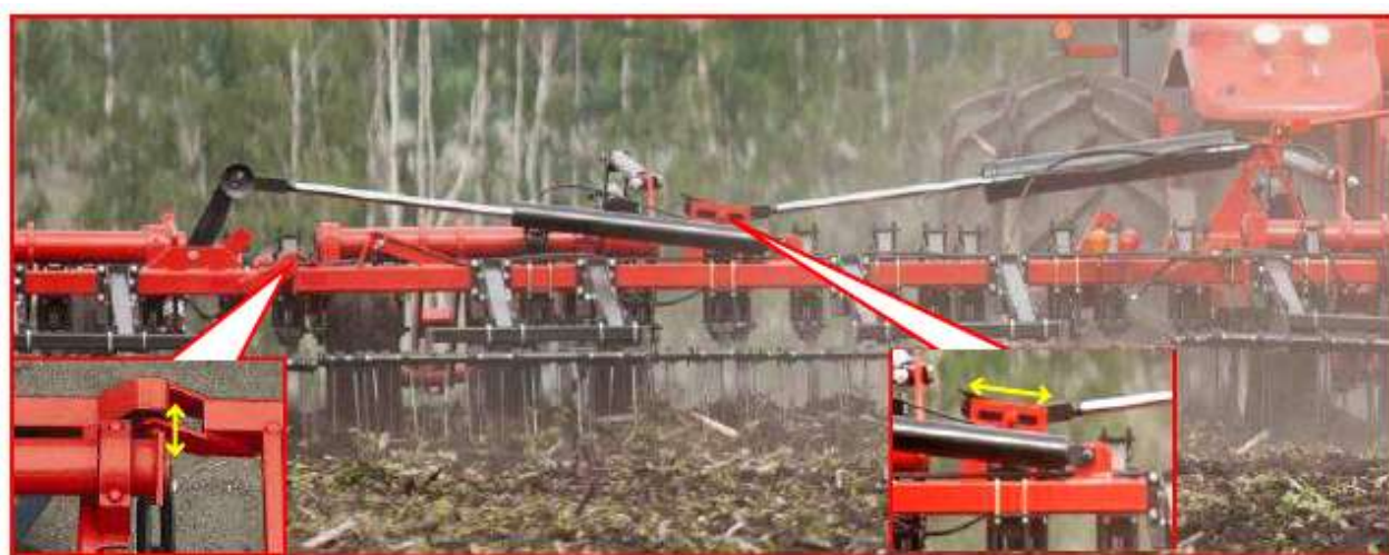
Рисунок 55– Горизонтальная подвижность рамы
