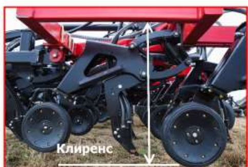
Рисунок 97 – Особенности конструкции рамы анкерных сеялок
