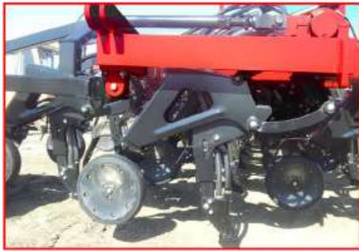
Рисунок 104 - Преимущества технологии ALIVE (Active Level Independent Vertical Emergence)
