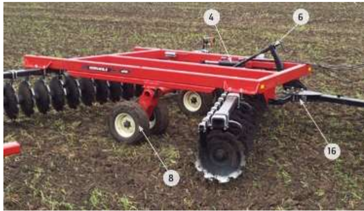
Рисунок 20 -Офсетная борона SD650 в транспортном положении
