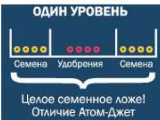
Рисунок 84 – Рабочие органы для посева DH730, 750
