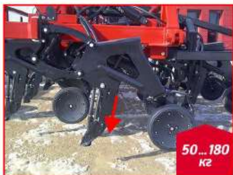
Рисунок 98 – Особенности конструкции качающего вала рамы
