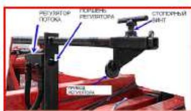
Рисунок 68– Регулировки и настройки культиваторов
