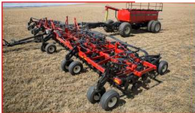
Рисунок 109 – Особенности конструкции самоустанавливающихся колёс анкерных сеялок
