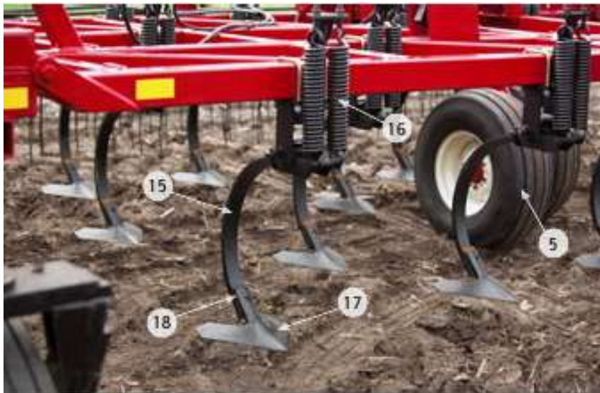
Рисунок 47 - Рабочие органы культиватора
