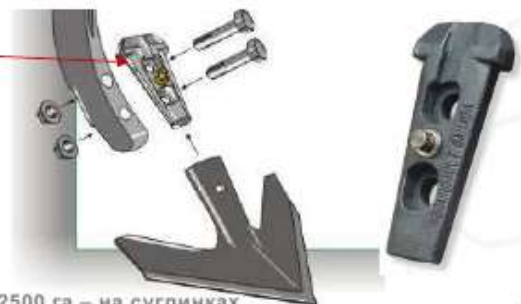
Рисунок 59– Особенности конструкции культиваторов (рабочие органы)
