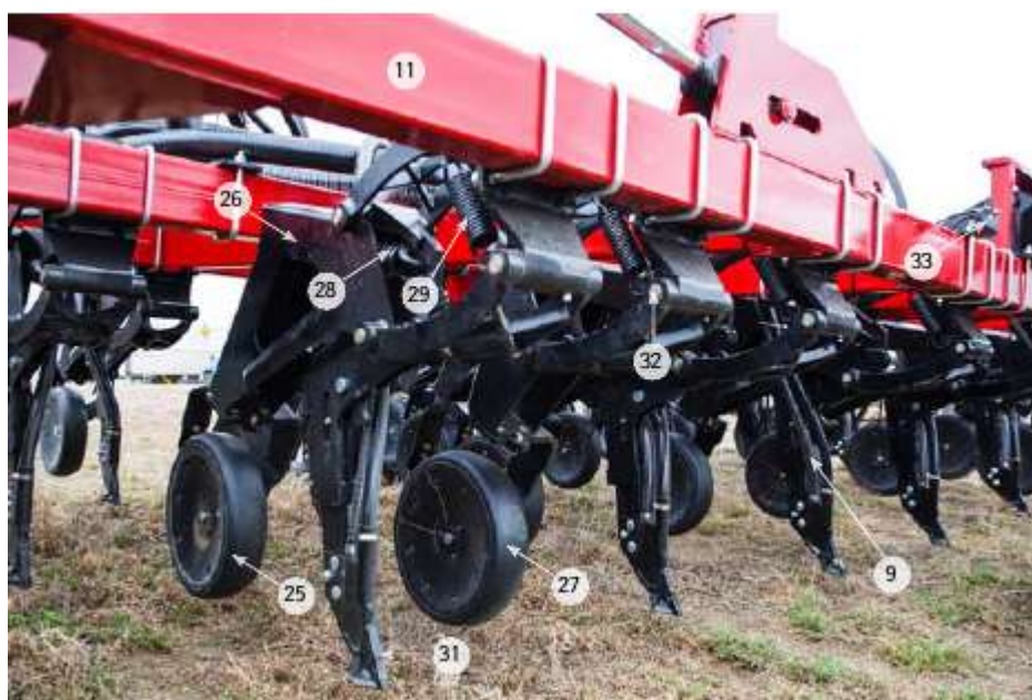
Рисунок 96 - Стойка сошника ALiVe
