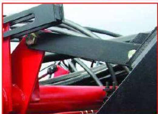
Рисунок 77 – Особенности конструкции качающихся валов пневматических сеялок ДН
