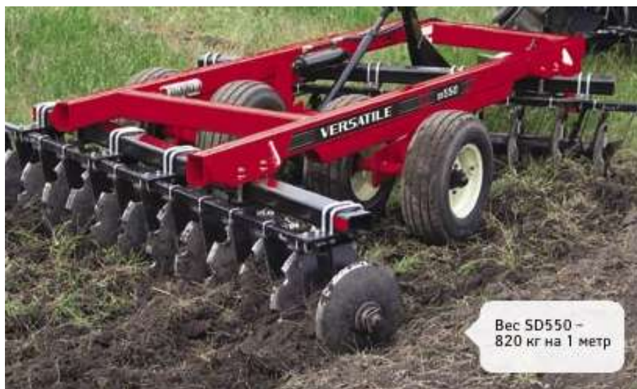
Рисунок 11– Офсетная дисковая борона SD550
