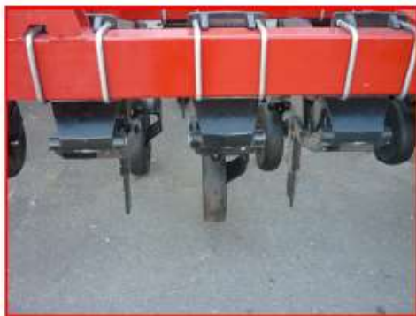
Рисунок 105 – Особенности конструкции анкерных сеялок
