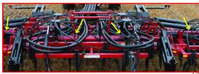
Рисунок 77 – Особенности конструкции качающихся валов пневматических сеялок ДН
