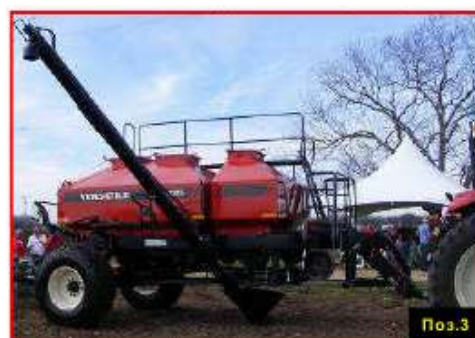
Рисунок 124 – Особенности конструкции шнека бункеров
