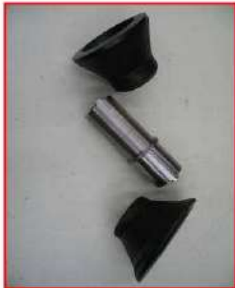
Рисунок 24– Особенности конструкции блокирующих проставок дисковых борн
