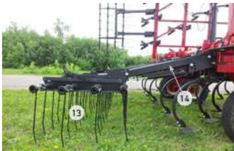
Рисунок 45 - Навесные пружинные бороны (4-рядные)
