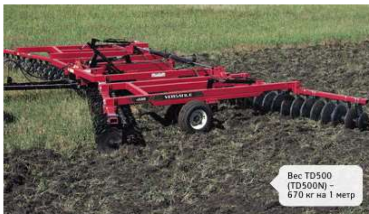
Рисунок 7– Тандемная дисковая борона TD500 (TD500N)
