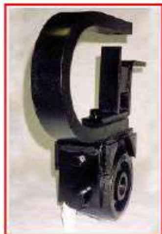
Рисунок 25– Особенности конструкции опорных кронштейнов дисковых борон
