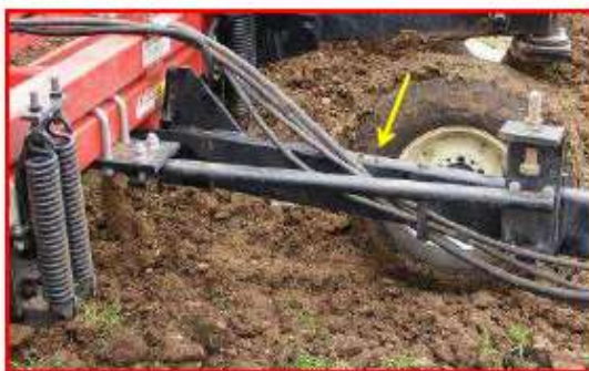
Рисунок 63– Безопасность при транспортировке культиваторов (стабилизатор сцепного устройства)
