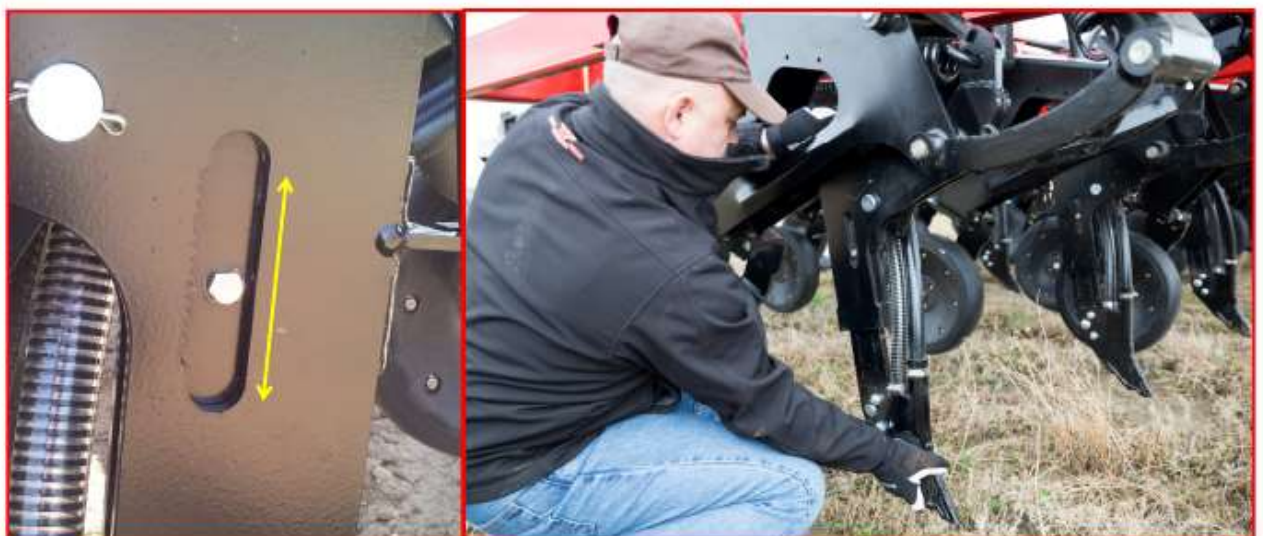
Рисунок 115 – Регулировки и настройки сеялки (положение ноги сошника)
