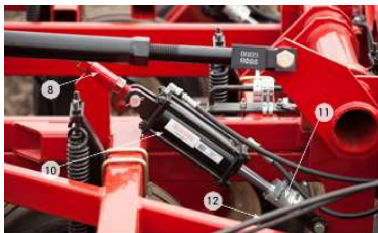
Рисунок 49 - Гидроцилиндр подъема С600 (всего 6)
