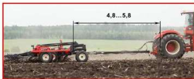
Рисунок 52– Копирование культиваторами рельефа поверхности поля
