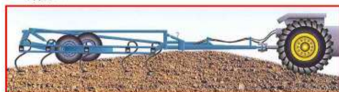
Рисунок 52– Копирование культиваторами рельефа поверхности поля
