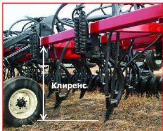
Рисунок 76 – Особенности конструкции рамы сеялок ДН
