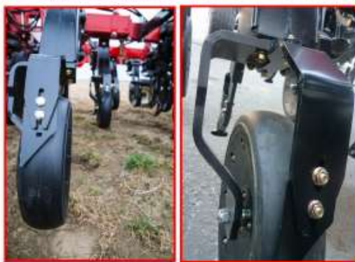
Рисунок 102 – Особенности конструкции катков анкерных сеялок
