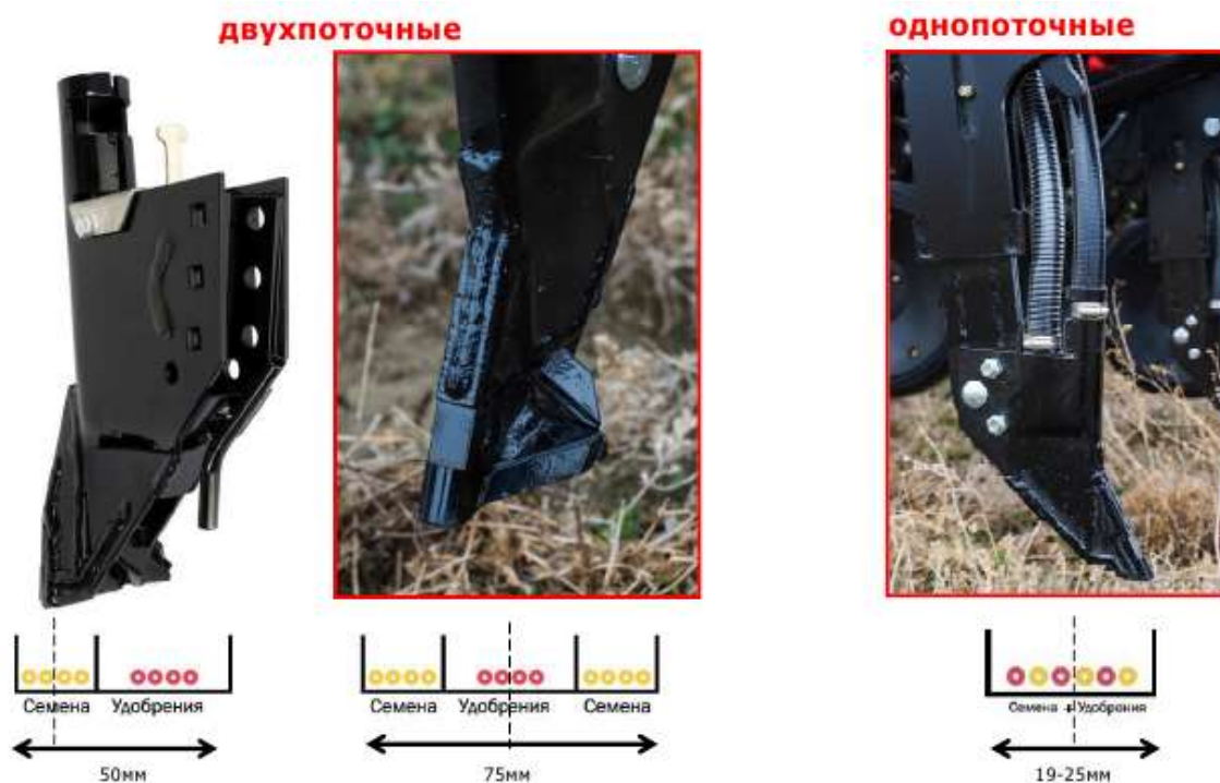
Рисунок 103 – Типы анкерных сошников, разработанных компанией «Atom-Jet» для Versatile ML
