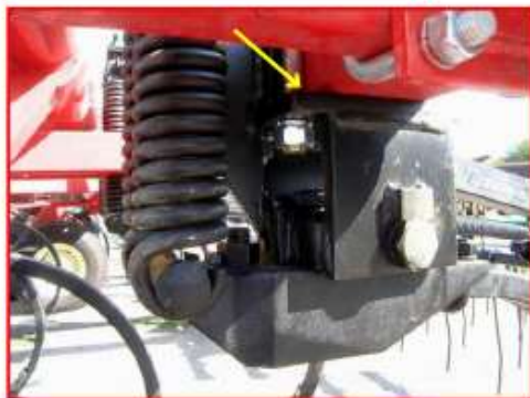
Рисунок 81 – Особенности конструкции стоек сеялок ДН
