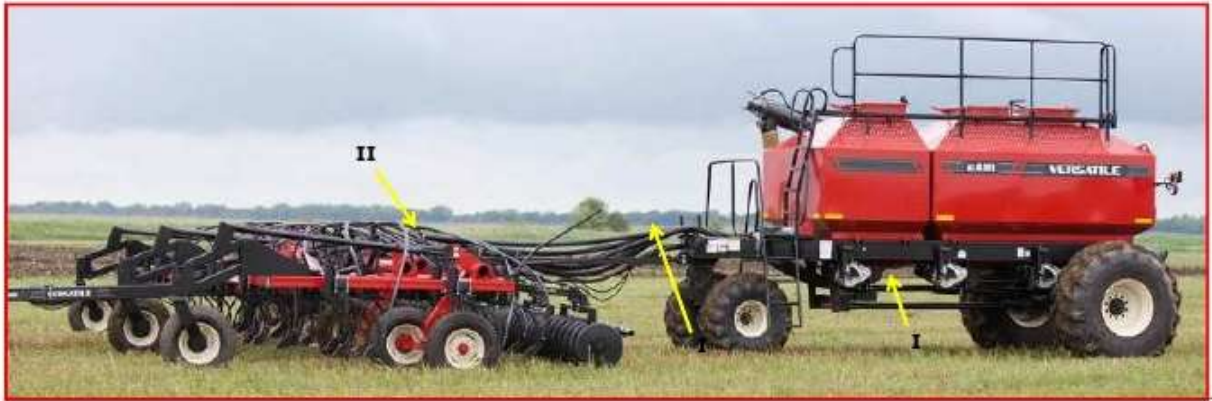
Рисунок 131 – Особенности конструкции бункеров
