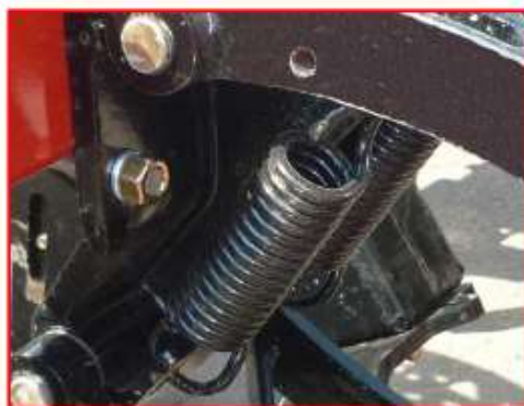
Рисунок 99 – Особенности конструкции сошников анкерных сеялок
