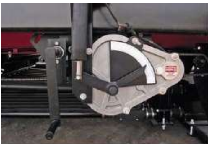
Рисунок 139 - Zero-Max с регулировкой нормы высева из кабины трактора
