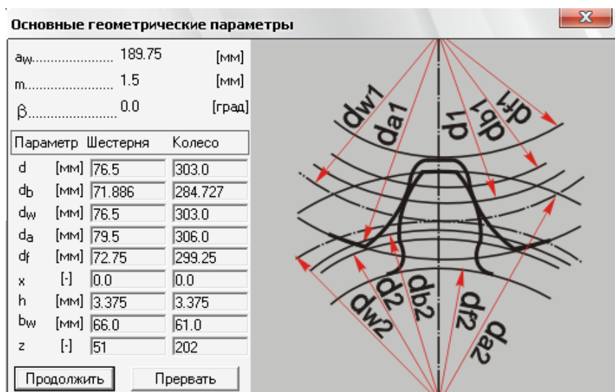
Рис. 3.9 Результаты расчёта основных размеров передачи
