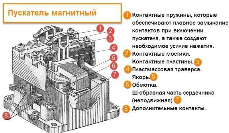
Рисунок 1.6 - Устройство электромагнитного пускателя
