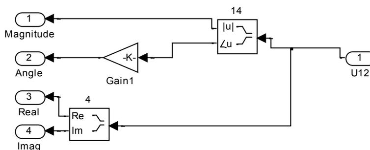
Модель (рис.3.2) содержит источник синусоидального напряжения AC Voltage Source U. Нагрузки: Series RLC Branch – цепи RL, R1L1C1 и R2L2C2. Вольтметры: Voltage Measurement – u31 и u12 (см. рис.3.1). Амперметры: Current Measurement – i в цепи RL; – i1 в цепи R1L1C1; – i2 в цепи R2L2C2.
