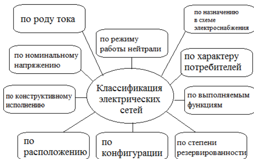
Рисунок 5 – Классификация электрических сетей
