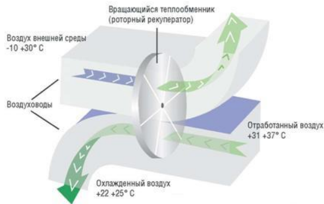
Рисунок 47 – Схема работы Киото-кулинга
