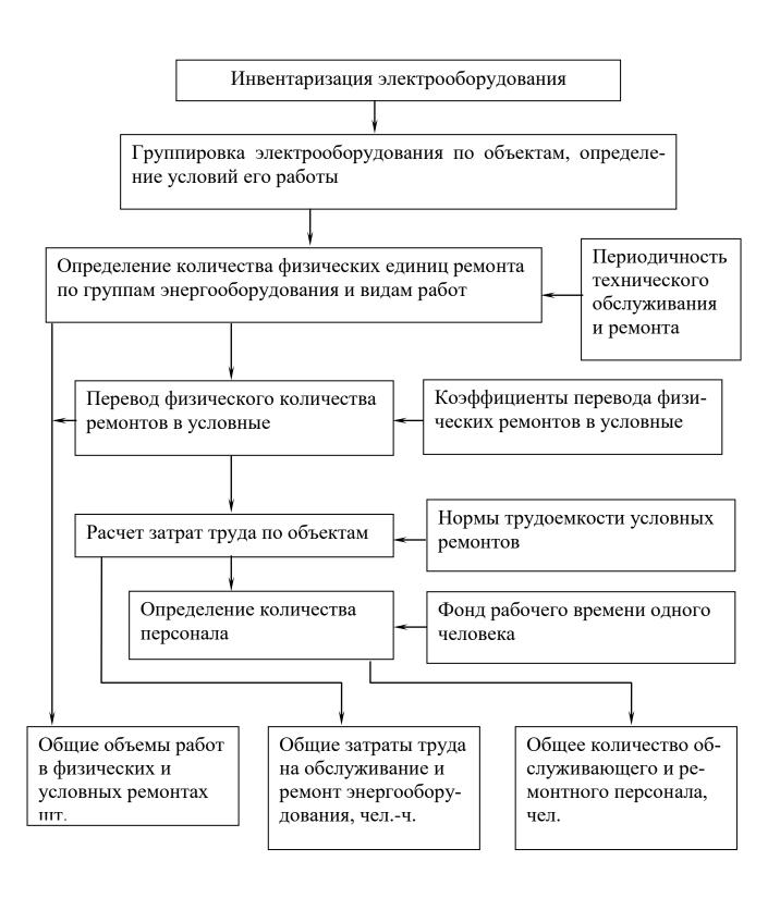
Рисисунок 1 - Схема объемов работ по обслуживанию и ремонту электрооборудования в хозяйстве
