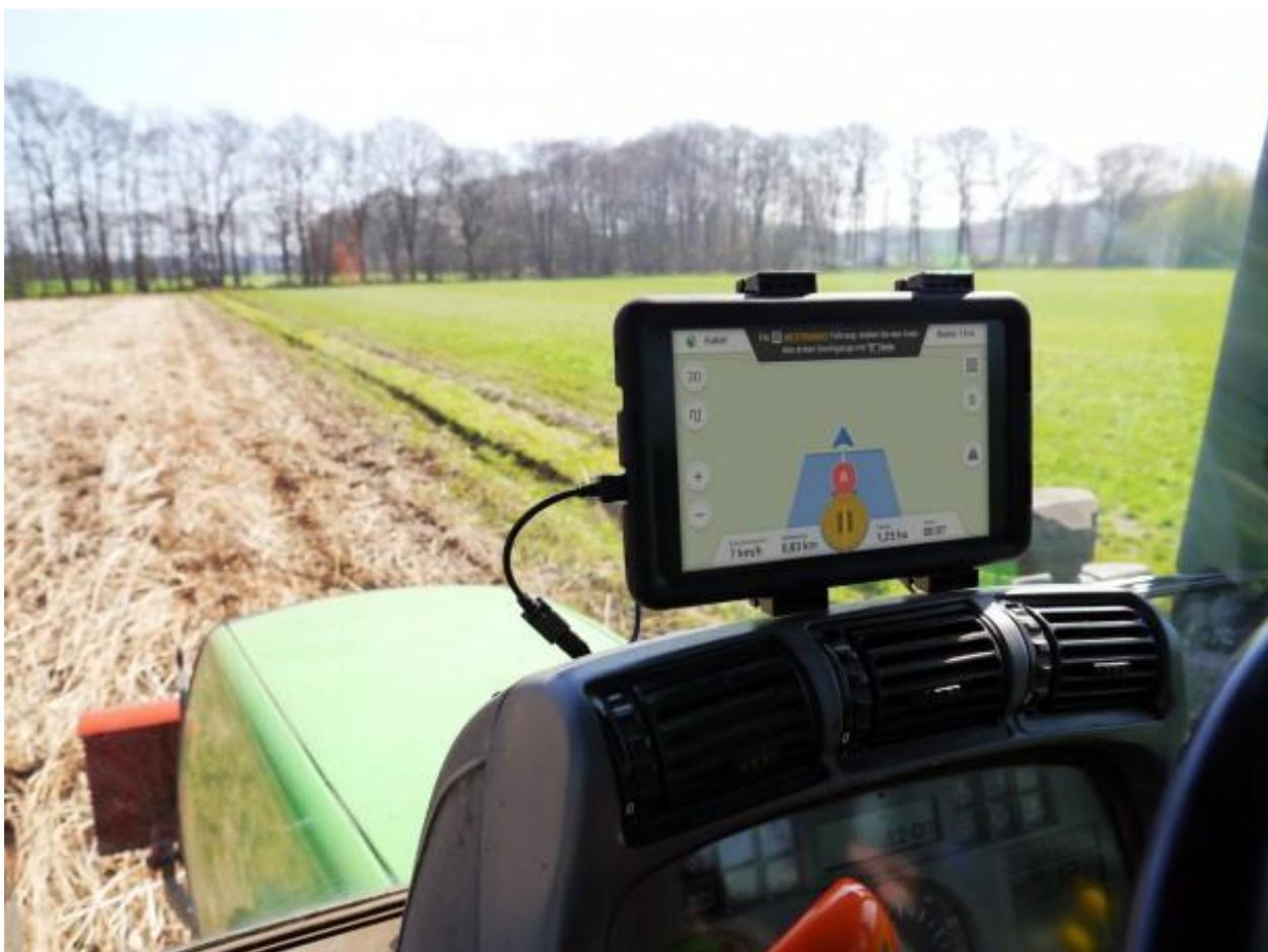
Рисунок 12 – GPS-приёмник, процессор и дисплей с курсоуказателем
