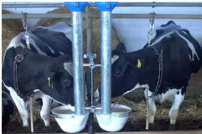
Рис. 23 Автоматическое водоснабжение на животноводческой ферме
