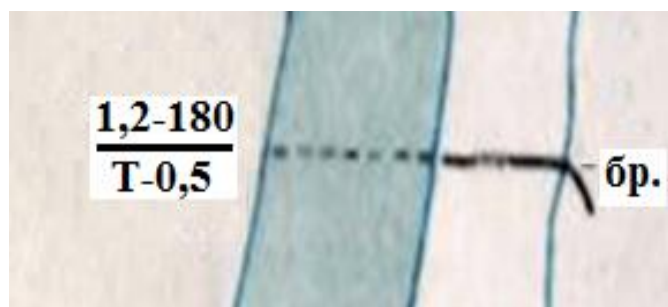
Рисунок 7.6 Пояснительные условные знаки: Брод: 1,2 – глубина, 180 – длина в метрах, Т – (твердый) характер грунта, 0,5 – скорость течения, м/сек.
