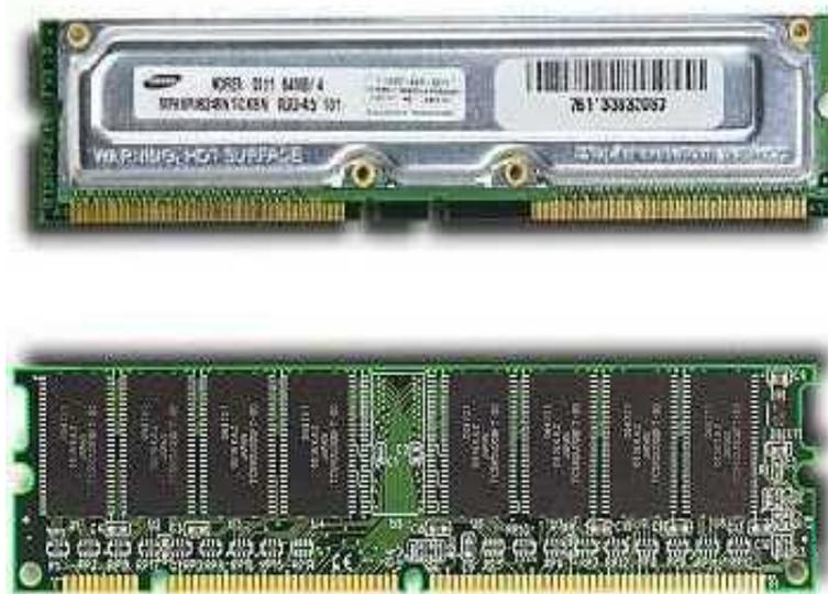
Рис. 2.5. Микросхемы памяти RIMM (сверху) и DIMM (снизу)
