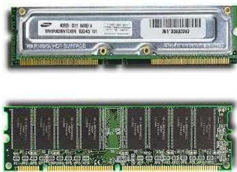
Рис. 2.5. Микросхемы памяти RIMM (сверху) и DIMM (снизу)
