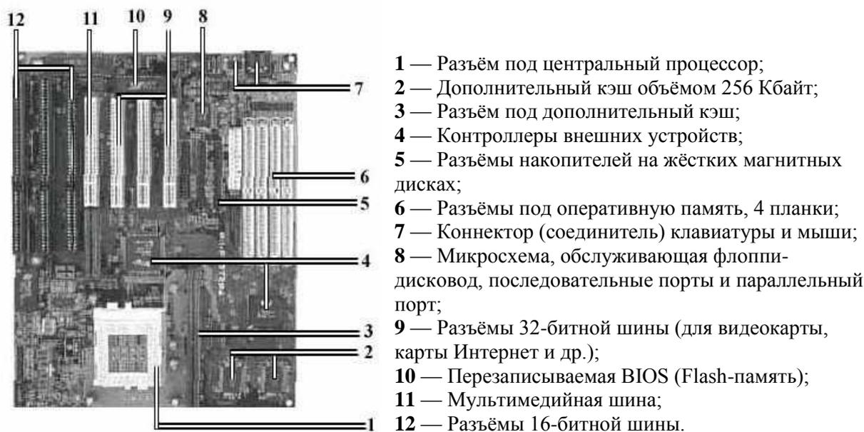
Рис. 2.9. Системная плата компьютера класса Pentium
