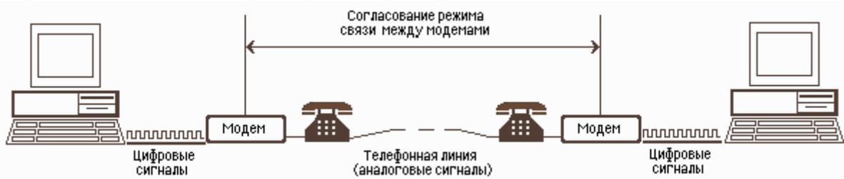
Рис. 2.7. Схема реализации модемной связи
