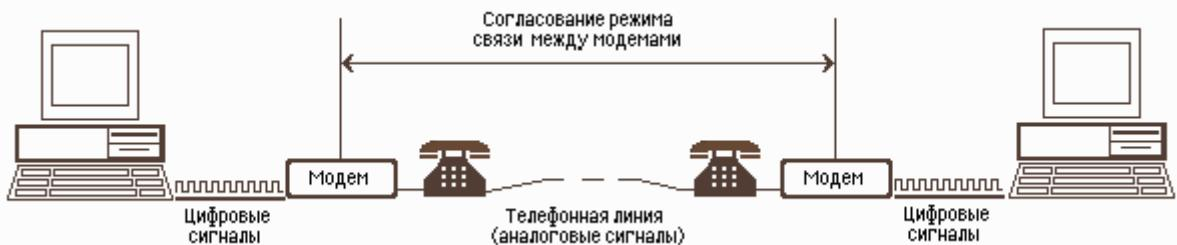
Рис. 2.7. Схема реализации модемной связи
