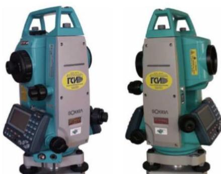
Рисунок 3.3.1 – Электронный тахеометр Sokkia SET 530RK3
