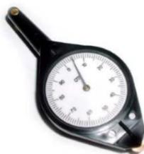
Рисунок 2.6.2 – Курвиметр механический
