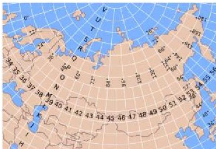
Рисунок 2.2.2 – Разграфка и номенклатура топографических карт масштаба 1:1000000
