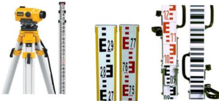
Рисунок 3.2.1 – Оптический нивелир и нивелирные рейки.
