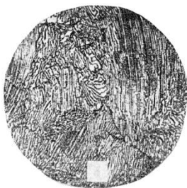
Рисунок 20 – Микроструктура эвтектоидной стали У8 (0,8 %C) ( \times 200 )
