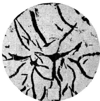
Рисунок 1 – Пластинчатая форма графитных включений –серый чугун (шлиф не травлён) ( \times 200 )
