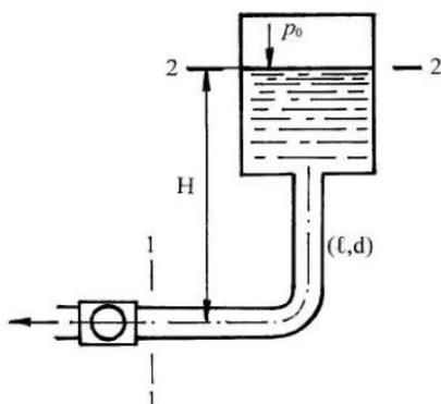
Определить абсолютное давление перед входом в насос при температуре рабочей жидкости  $t = 25^\circ\text{C}$  ( $\nu = 0,2 \cdot 10^{-4} \text{ м}^2/\text{с}$ ).
