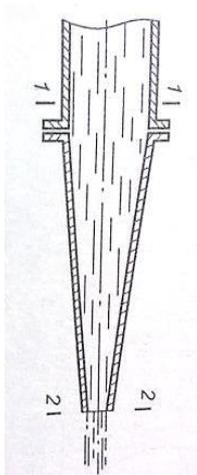
Рисунок 3.7 – Сопло гидромонитора, к задаче №3
