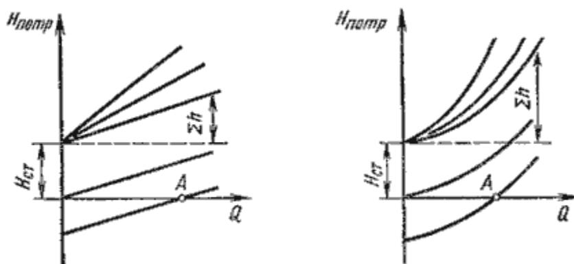
Рисунок 4.2 – Зависимости потребных напоров от расхода жидкости в трубопроводе
