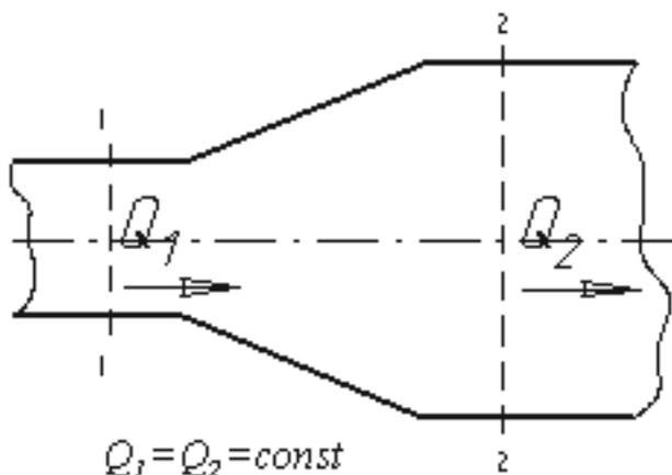
Рисунок 3.3 – Труба с переменным диаметром при постоянном расходе
