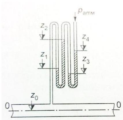
**Задача №1** Определите избыточное давление воды в трубе по показаниям батарейного ртутного манометра. Отметки уровней ртути по оси трубы:  $Z_1, Z_2, Z_3, Z_4$ .
