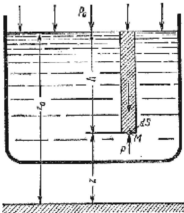
Рисунок 2.1 - Схема для вывода основного уравнения гидростатики
