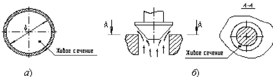
Рисунок 3.1 – Живые сечения: а - трубы, б – клапана
