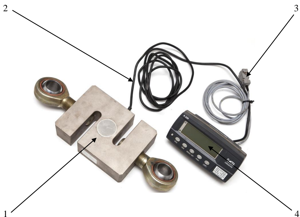
Рисунок 35 – Динамометр ДОР-3-100И: 1 – силовой блок с тензометрическим датчиком и проушинами; 2 – кабель соединительный; 3 – кабель «СОМ-Порт» для подключения к ПК; 4 – электронный блок с цифровым табло
