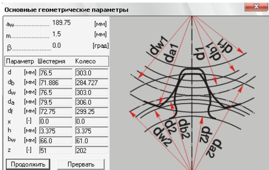
Рис. 3.9 Результаты расчёта основных размеров передачи
