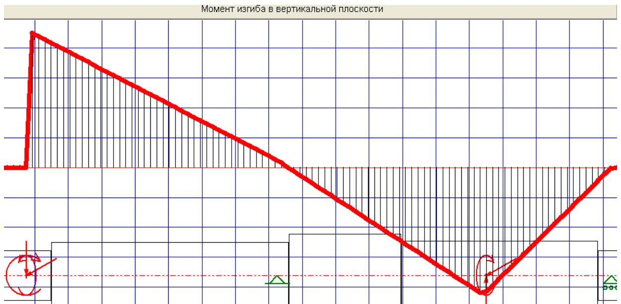
Рисунок 25 - Эпюра моментов изгиба в вертикальной плоскости
