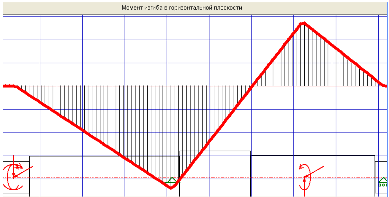
Рисунок 26- Эпюра моментов изгиба в горизонтальной плоскости
