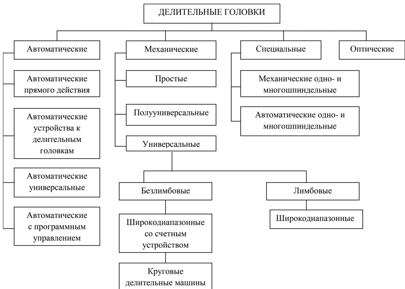
Рисунок 1 – Классификация делительных головок
