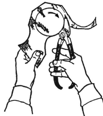
Рисунок 24 – Резка листового металла на рычажных ножницах
