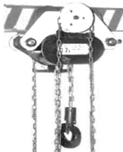
Рисунок 1.43 – Таль с комбинированным приводом механизированным или ручным с помощью цепи и редуктора
