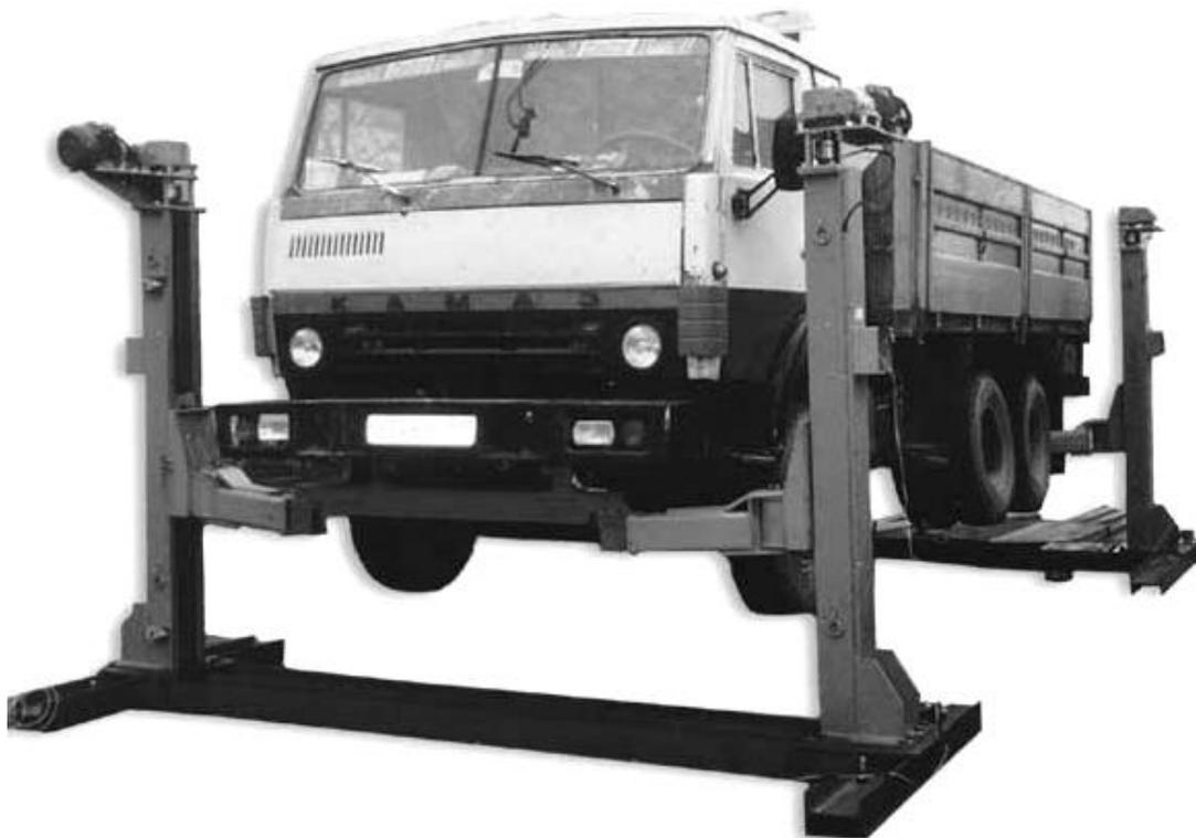
Рисунок 1.23 – Стационарный подъёмник ПС - 16
