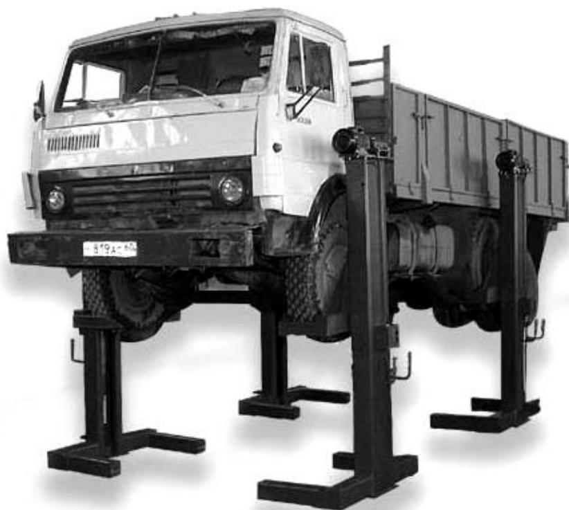
Рисунок 1.24 – Передвижной подъёмник ПП - 20
