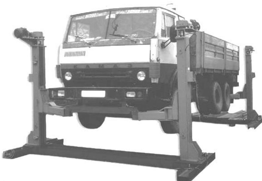
Рисунок 1.20 – Стационарный подъёмник ПС - 10
