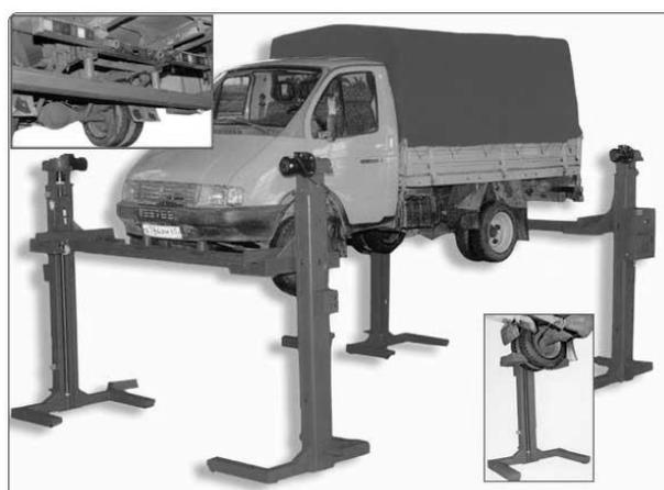
Рисунок 1.19 – Передвижной подъёмник ПП - 6
