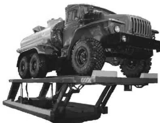
Рисунок 1.15 – Подъёмник гидравлический Г - 272 (12)
