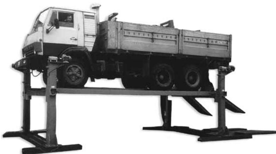
Рисунок 1.28 – Подъёмник ПЛ - 10
