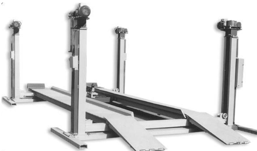
Рисунок 1.27 – Подъёмник ПЛ - 5
