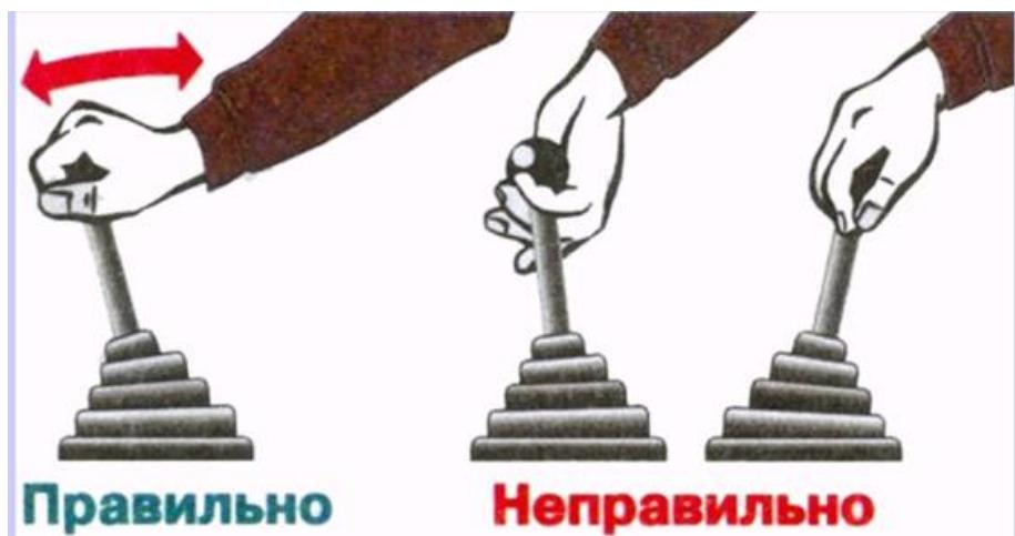
Рисунок 8 – Положение кисти руки при переключении передач
