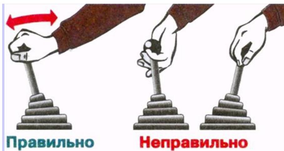
Рисунок 8 – Положение кисти рук при переключении передач
