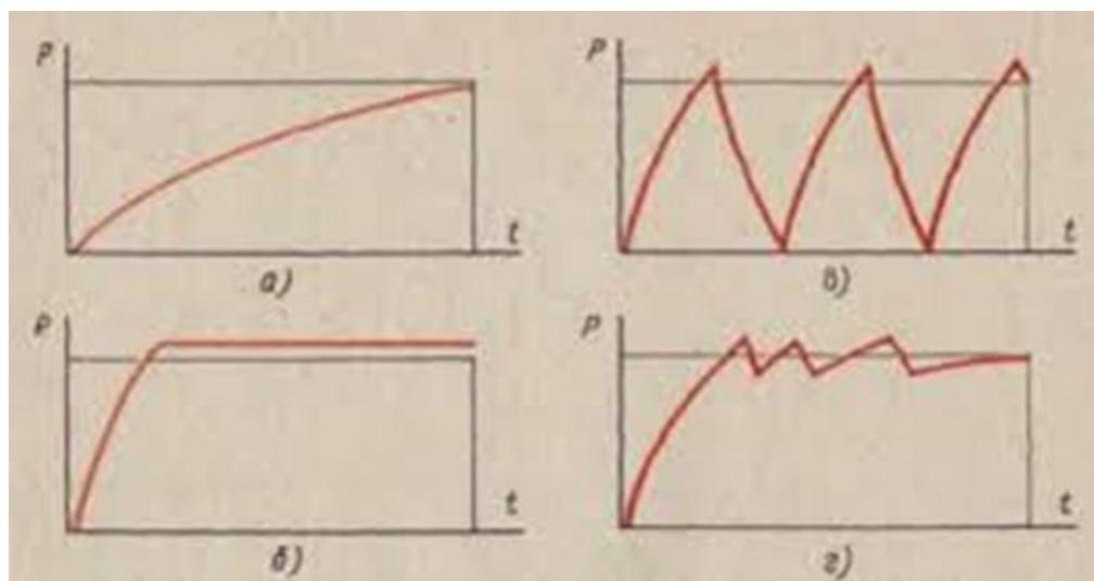
*a – плавный; б – резкий; в – прерывистый; г – ступенчатый; t – время, необходимое для полной остановки автомобиля; Р – усилие на педали тормоза.*
