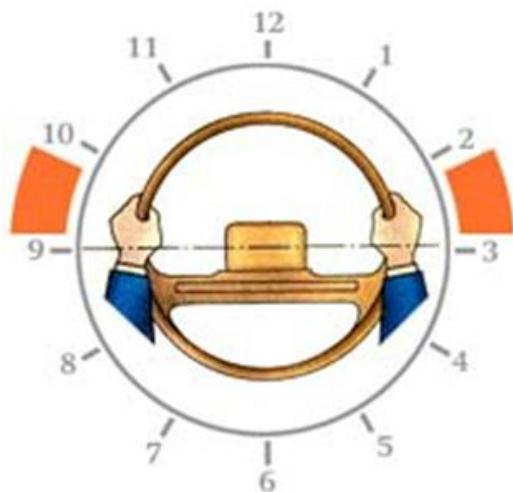
**Рисунок 1.4 – Положение рук водителя на рулевом колесе**
