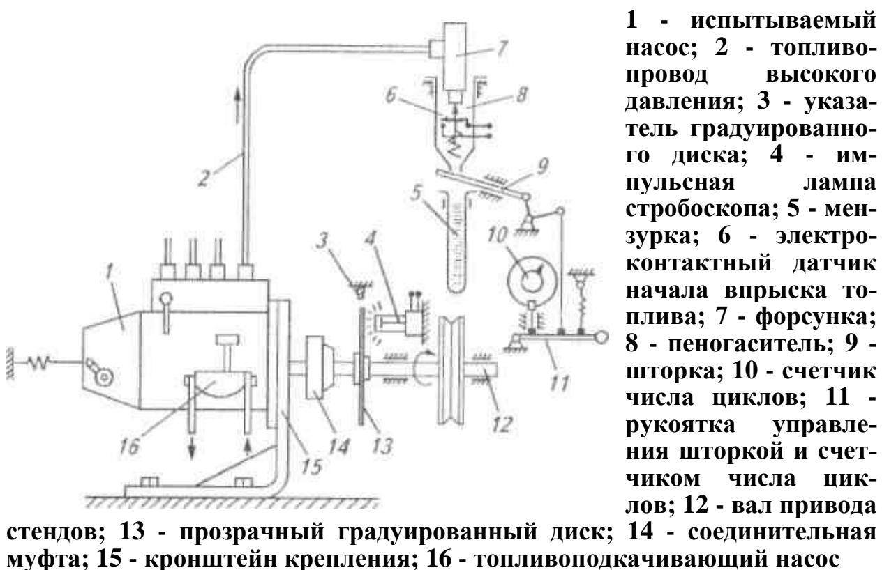
Рисунок 10 – Схема работы стенда КИ-921 М (СДТА-2) при испытании топливного насоса высокого давления
