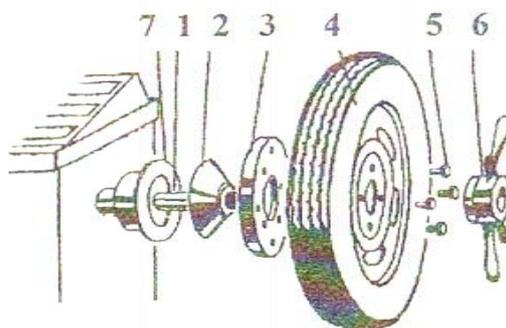
1 – вал в сборе; 2 – конус 47...70 мм; 3 – фланец; 4 – балансируемое колесо; 5 – болт; 6 – прижимная гайка с кольцом; 7 – упор
