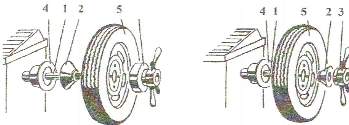
1 – вал в сборе; 2 – конус; 3 – прижимная гайка с чашкой; 4 – упор; 5 – балансируемое колесо
