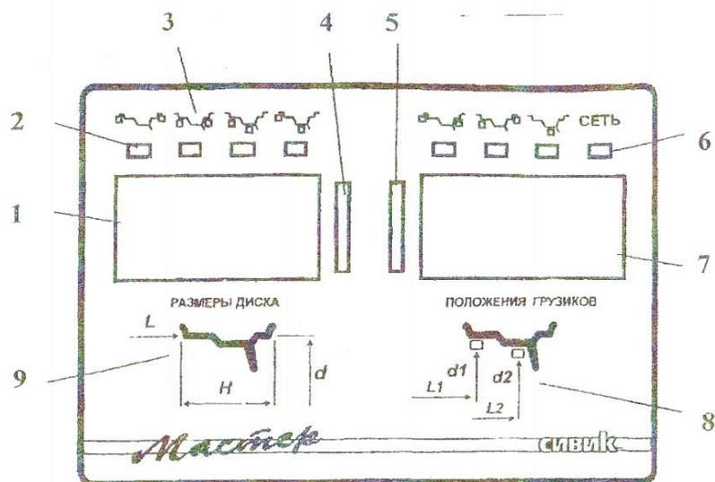
1 – информационный индикатор массы корректирующего груза в левой плоскости коррекции; 2 – индикатор типа колеса; 3 – схема размещения грузов на обод; 4 – индикатор положения корректирующего груза в левой плоскости коррекции; 5 – индикатор положения груза в правой плоскости коррекции; 6 – индикатор включения станка; 7 – информационный индикатор массы корректирующего груза в правой плоскости коррекции; 8 – схема обозначений положения грузов; 9 – схема обозначений размеров колеса.
