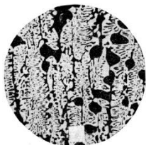
Рисунок 6 – Микроструктура заэвтектического белого чугуна – 5%С, (×200)
