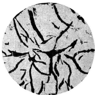
Рисунок 1 – Пластинчатая форма графитных включений –серый чугун (шлиф не травлён) (×200)
