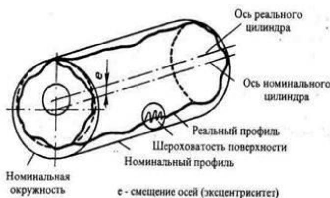
Рис. 1.1. Искажение размеров и формы цилиндра после изготовления
