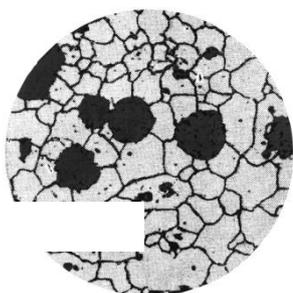
Рисунок 16 – Микроструктура высокопрочного чугуна на феррито-перлитной основе ( $\times 200$ )
