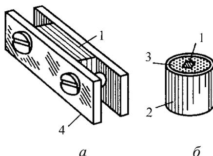
1 – образец; 2 – оправка; 3 – сера или легкоплавкий сплав; 4 – струбцина
