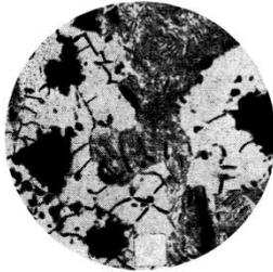
Рисунок 13 – Микроструктура ковкого чугуна на феррито-перлитной основе (×200)
