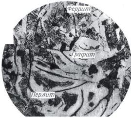
Рисунок 8 – Микроструктура серого чугуна на феррито-перлитного основе (×200)
