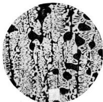
Рисунок 6 – Микроструктура *заэвтектического* белого чугуна – 5%С, ( $\times 200$ )
