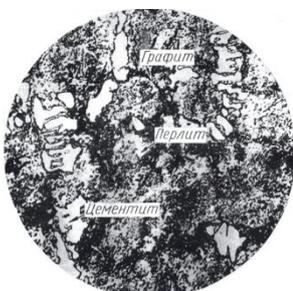
Рисунок 10 – Микроструктура серого чугуна
