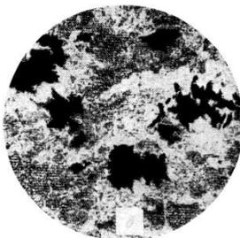
Рисунок 14 – Микроструктура ковкого чугуна на перлитной основе (×200)
