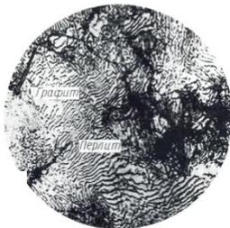
Рисунок 9 – Микроструктура серого чугуна на перлитной основе (×200)
