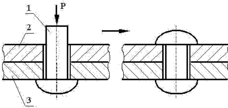
Рисунок 1. Заклепочное соединение:
