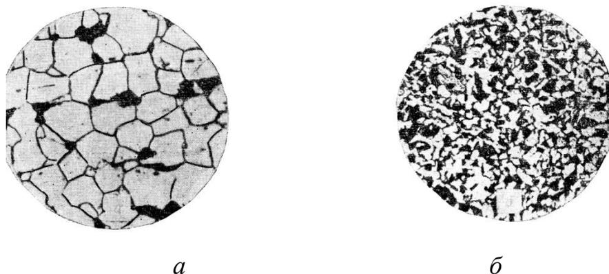
Рисунок 19 – Микроструктура доэвтектоидных сталей с различным содержанием углерода ( $\times 200$ ):
