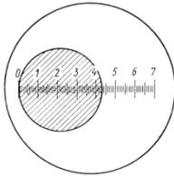
Рисунок 2 – Измерение по шкале лупы диаметра отпечатка
