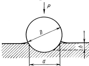
Рисунок 1 – Схема испытания на твёрдость по способу Бринелля
