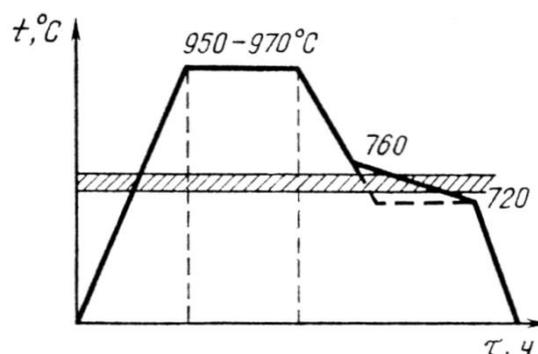
Рисунок 11 – Схема отжига белого чугуна на ковкий чугун
