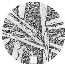
Рисунок 4 – Микроструктура доэвтектического белого чугуна – 3%С, ( $\times 200$ )
