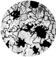
Рисунок 12 – Микроструктура ковкого чугуна на ферритной основе (×200)
