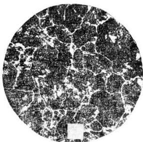
Рисунок 21 – Микроструктура заэвтектоидной стали У12 (1,2 %С) (×200)
