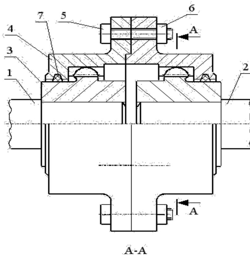
На концы соединяемых валов (1) и (2) насаживают полумуфты (3) с наружными зубьями, которые сцепляются с внутренними зубьями обойм (4). Обоймы соединяют между собой болтовыми соединениями (5 – болт, 6 – гайка). Упругие вкладыши (7) амортизируют удары обоймы с полумуфтами
