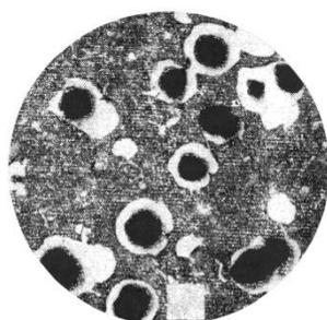
Рисунок 15 – Микроструктура высокопрочного чугуна на ферритной основе ( $\times 200$ )
