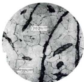
Рисунок 7 – Микроструктура серого чугуна на ферритной основе (×200)
