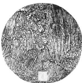
Рисунок 20 – Микроструктура эвтектоидной стали У8 (0,8 %С) ( $\times 200$ )
