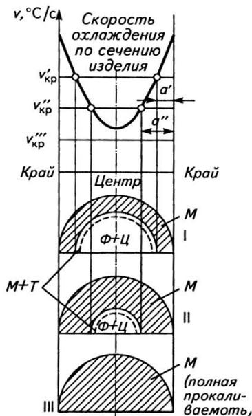
$a'$  и  $a''$  – глубина закалённого слоя при разных скоростях закалки;
