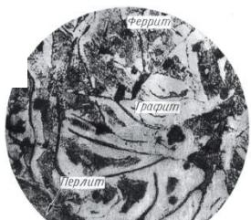
Рисунок 8 – Микроструктура серого чугуна на феррито-перлитного основе ( $\times 200$ )
