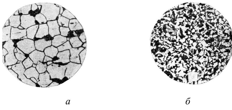
Рисунок 19 – Микроструктура доэвтектоидных сталей с различным содержанием углерода ( $\times 200$ ):
