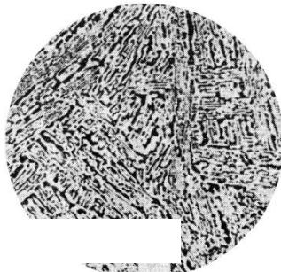
Рисунок 5 – Микроструктура *эвтектического* белого чугуна – 4,3%С, ( $\times 200$ )
