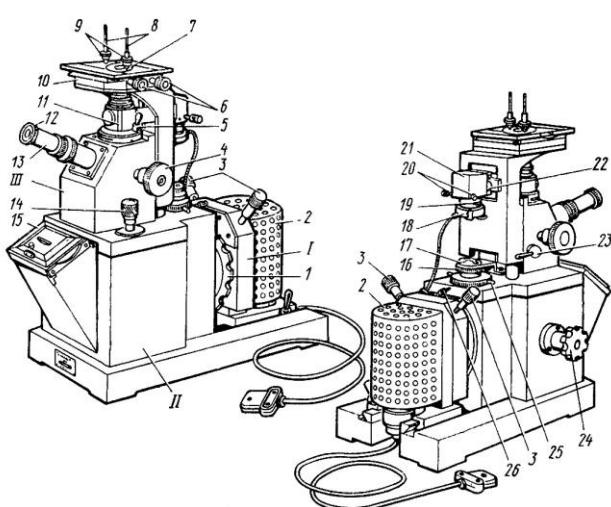
17 – осветительная линза; 18 – фотозатвор; 19 – поводок; 20 – центрировочные винты; 21 – кожух; 22 – рамка с линзами; 23 – зажимной винт; 24 – рукоятка переключения фотоокуляров; 25, 26 – винт
