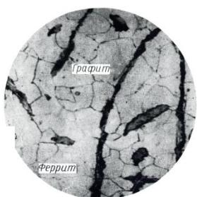
Рисунок 7 – Микроструктура серого чугуна на ферритной основе ( $\times 200$ )
