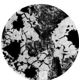
Рисунок 13 – Микроструктура ковкого чугуна на феррито-перлитной основе ( $\times 200$ )
