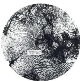
Рисунок 9 – Микроструктура серого чугуна на перлитной основе ( $\times 200$ )
