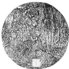
Рисунок 20 – Микроструктура эвтектоидной стали У8 (0,8 %C) ( $\times 200$ )
