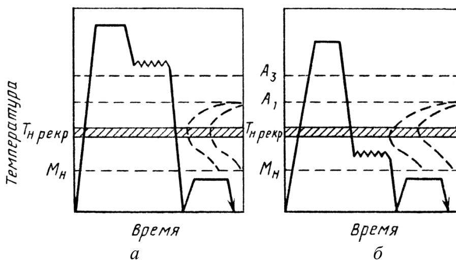
Рисунок 6 – Принципиальная схема упрочнения сталей методами термомеханической обработки:
