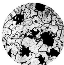
Рисунок 12 – Микроструктура ковкого чугуна на ферритной основе ( $\times 200$ )
