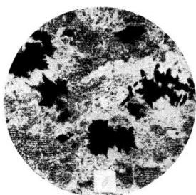
Рисунок 14 – Микроструктура ковкого чугуна на перлитной основе ( $\times 200$ )
