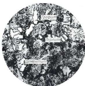
Рисунок 10 – Микроструктура серого чугуна
