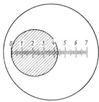
Рисунок 2 – Измерение по шкале лупы диаметра отпечатка
