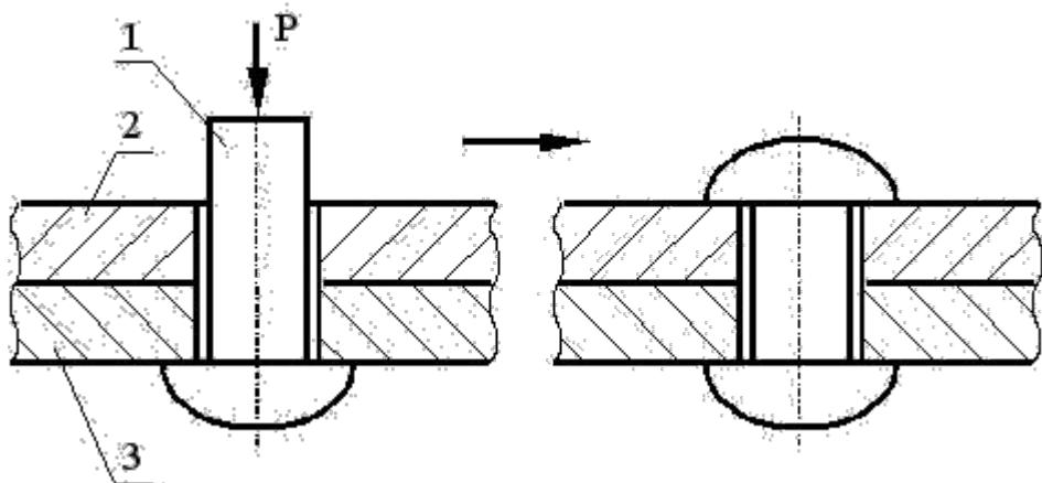
Рисунок 1. Заклепочное соединение:
