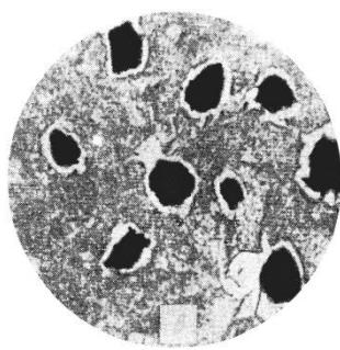
Рисунок 17 – Микроструктура высокопрочного чугуна на перлитной основе ( $\times 200$ )
