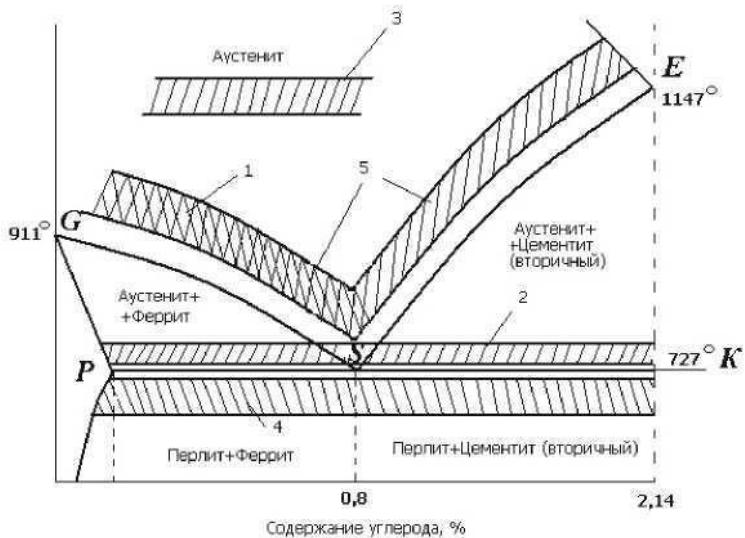
Рис. 23. Области температур для различных видов отжига:
