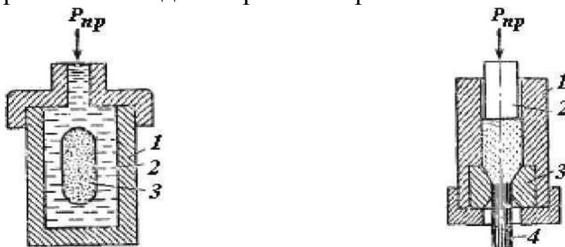
Рис. 29. Схема гидростатического прессования: 1 - контейнер; 2 - пуансон; 3 - мундштук; 4 - заготовка
