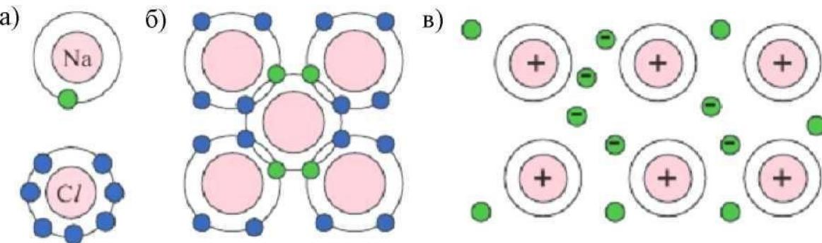
Рис. 3. Основные виды атомных связей а - ионная связь; б - ковалентная связь; в - металлическая связь
