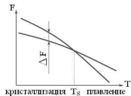
Рис. 8. Зависимости вещества от твёрдого и жидкого состояний
