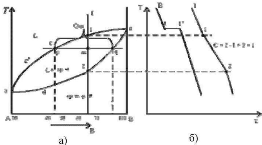
Рис. 21. Диаграмма состояния сплавов с неограниченной растворимостью компонентов в твёрдом состоянии (а); кривые охлаждения типичных сплавов (б)
