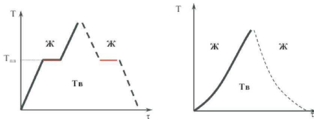
Рис. 1. Температурные кривые кристаллического и аморфного вещества
