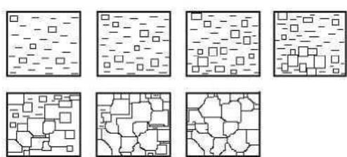
Рис. 13. Схема кристаллизации и роста кристаллов
