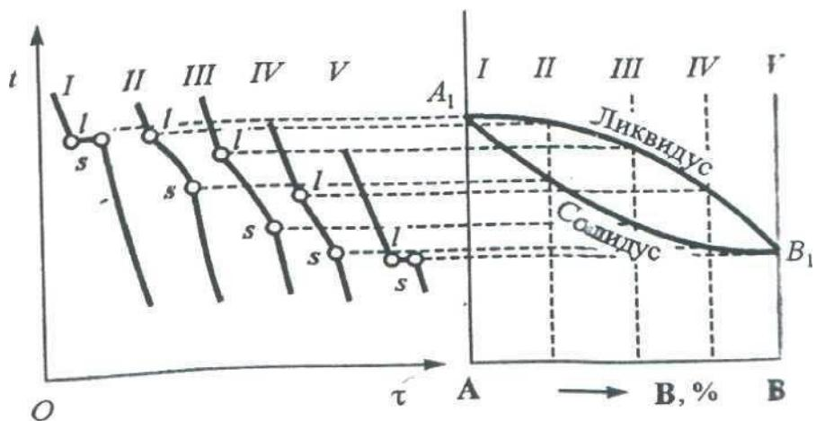
Рис. 20. Схема построения диаграммы состояния
