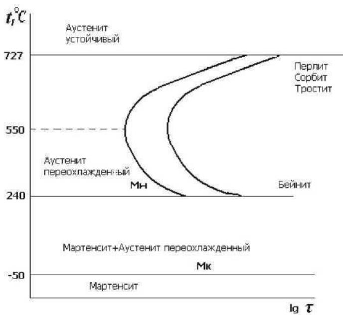
Рис. 24. Диаграмма изотермического превращения аустенита эвтектоидной стали (схема)
