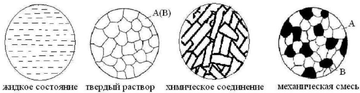
Рис. 17. Микроструктура сплава
