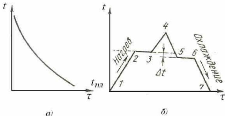
Рис. 10. Кривые охлаждения и плавления
