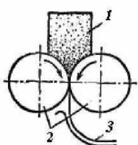
деформирования в холодном или горячем состоянии. Прокатку производят в вертикальном, наклонном и горизонтальном направлениях. Наилучшие условия формообразования изделия создаются при вертикальной прокатке. Сначала порошок из бункера поступа-
