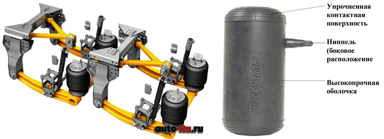
Рисунок 7 – Пневматическая баллонная подвеска автомобиля
