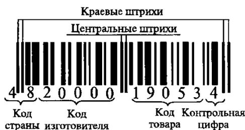
Штриховой код считывается сканером (контрольное число предназначено для проверки правильности считывания кода).
