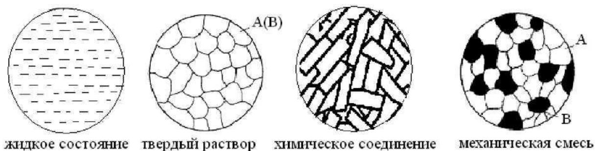
Рис. 17. Микроструктура сплава
