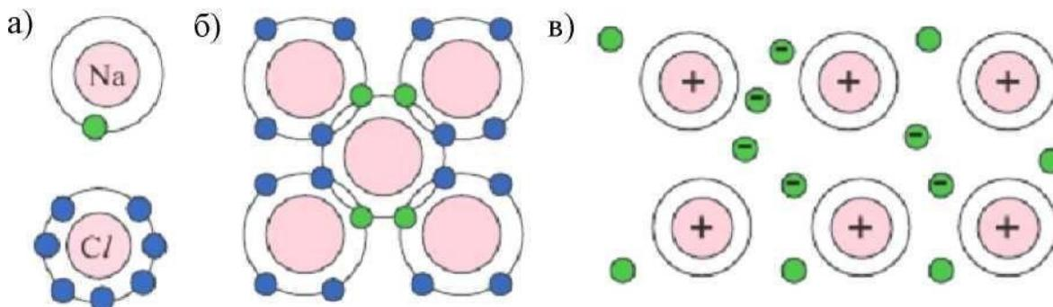
Рис. 3. Основные виды атомных связей а - ионная связь; б - ковалентная связь; в - металлическая связь
