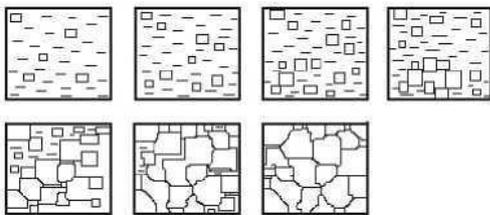
Рис. 13. Схема кристаллизации и роста кристаллов
