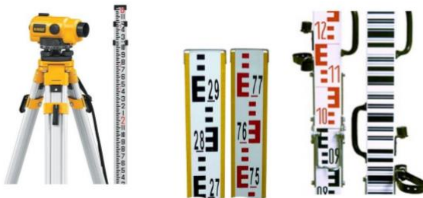
Рисунок 3.2.1 – Оптический нивелир и нивелирные рейки.
