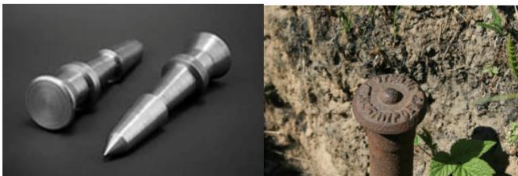
Рисунок 1.13.3 – стенные и грунтовые реперы
