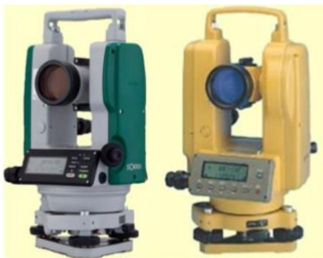
Рисунок 3.1.8 – Электронные теодолиты серии DT (слева) и ET (справа)
