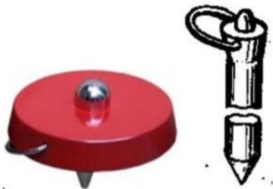
Рисунок 4.4.1 – Нивелирный башмак и нивелирный костыль
