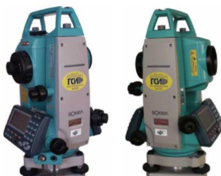
Рисунок 3.3.1 – Электронный тахеометр Sokkia SET 530RK3
