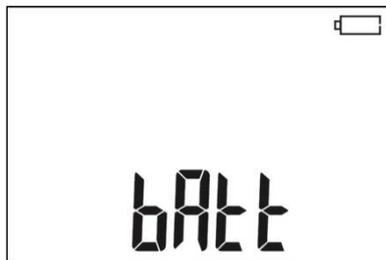
2. Аккумулятор полностью разряжен, все измерения блокируются.
