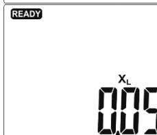
$X_L$  реактивное сопротивление петли короткого замыкания
