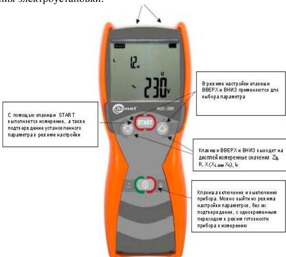
Рисунок 5.1 – Прибор ТС-20 для измерения петли короткого замыкания
