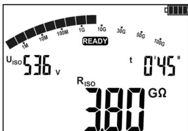
После окончания или прерывания измерения, на дисплее можно считать результат. Отображаются результаты всех измерений, которые были проведены (также в случае прерывания измерения, например, по истечении 60 с). Если прибор переключился в состояние готовности, то результат измерения можно вернуть на экран клавишей **ВВОД**.
