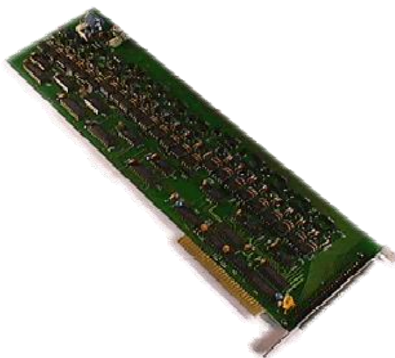
Рис. 9 Модуль ввода АМР 1.07.
