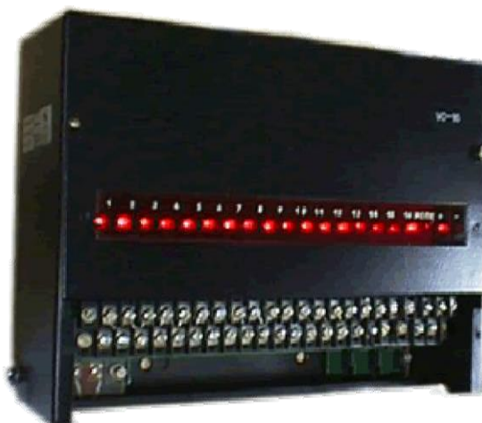
Рис. 6 Устройство подключения удаленных счетчиков "УС-16" АМР16.00.00.
