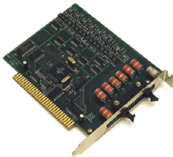
Рис. 7 Модуль 8×УС16 для подключения концентраторов.
