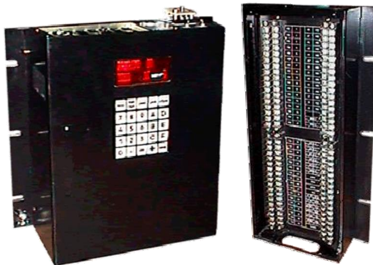
Рис. 5 Устройство сбора и передачи данных "Ток-С".
