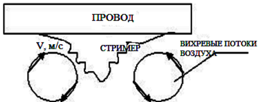
Рисунок 5.2 – Образование вихревых потоков в зоне стримерной короны
