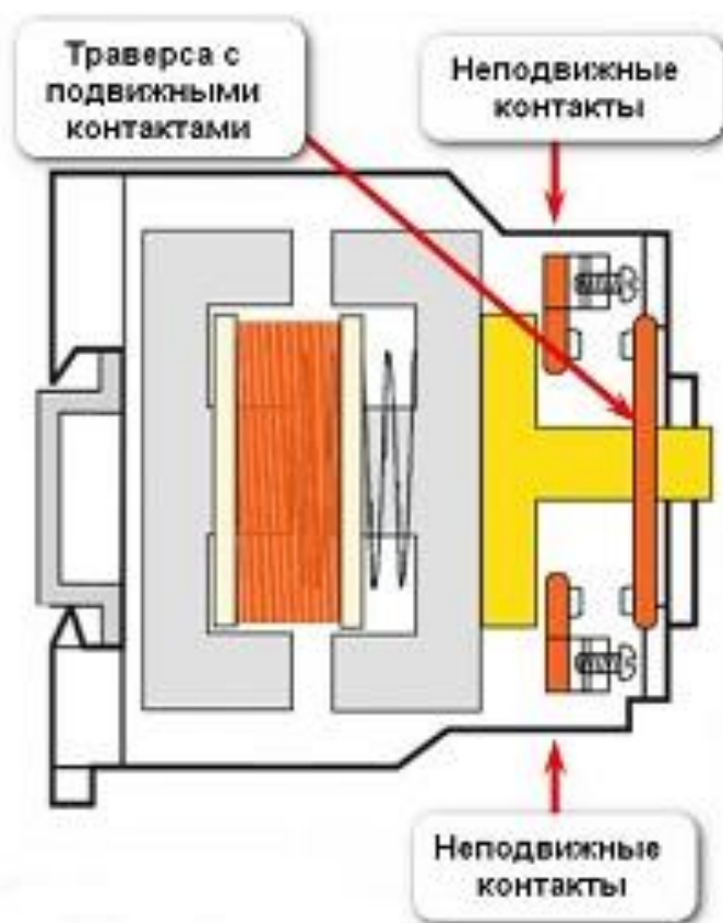
Рисунок 2.6 – Устройство магнитного пускателя
