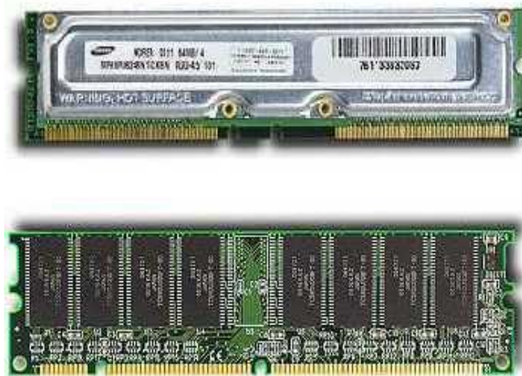
Рис. 2.5. Микросхемы памяти RIMM (сверху) и DIMM (снизу)
