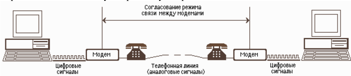
Рис. 2.7. Схема реализации модемной связи
