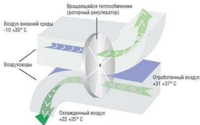
Рисунок 47 – Схема работы Киото-кулинга
