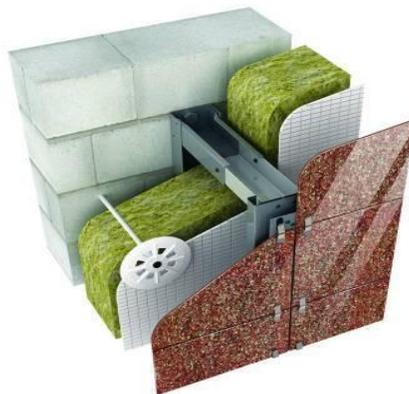
Рисунок 20 – Местный разрез многослойного ограждения с навесным вентилируемым фасадом
