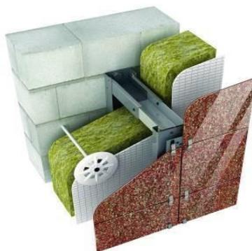
Рисунок 35 – Местный разрез многослойного ограждения с навесным вентилируемым фасадом
