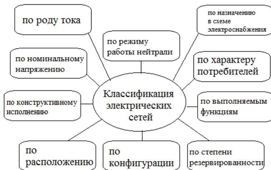
Рисунок 5 – Классификация электрических сетей
