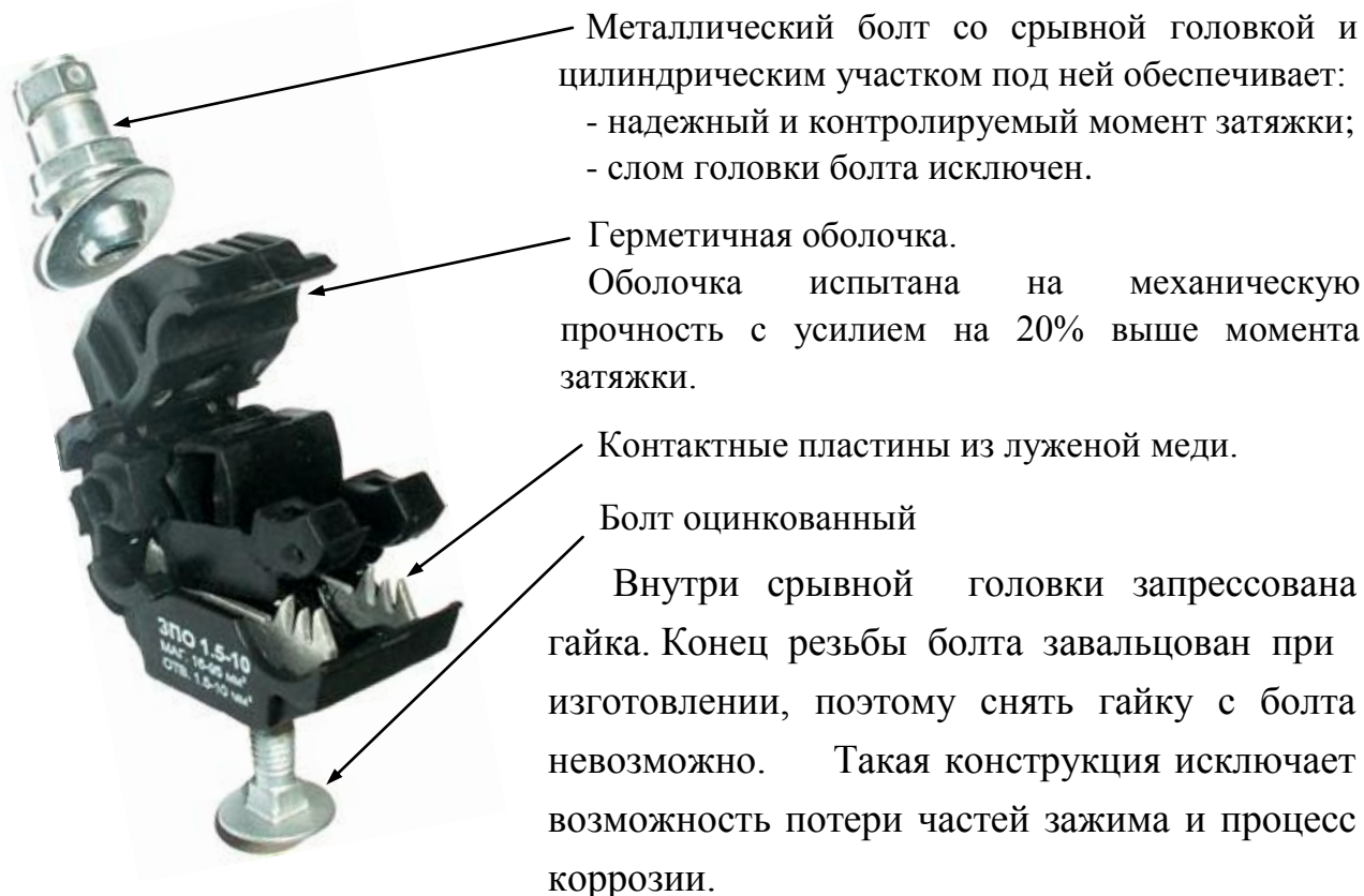
Рис. 83. Устройство прокалывающего зажима ЗПО 1,5-10.
