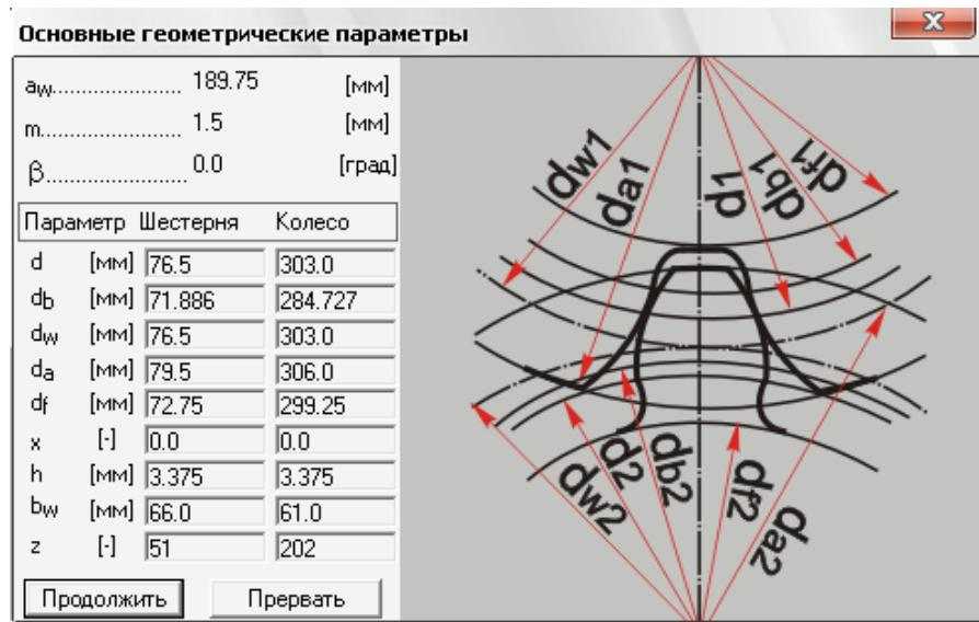
Рис. 3.9 Результаты расчёта основных размеров передачи
