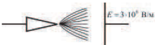
Рис.58. Схема коронного разряда
