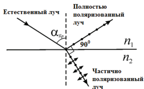
Рисунок 33 – Поляризация света при отражении от диэлектрика
