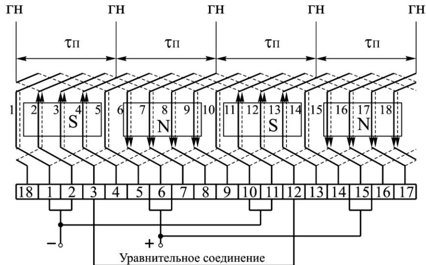
Рисунок 1.2 – Схема-развертка простой петлевой обмотки
