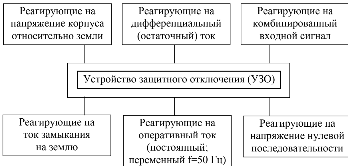
Рис. 5. Классификация УЗО по виду входного сигнала
