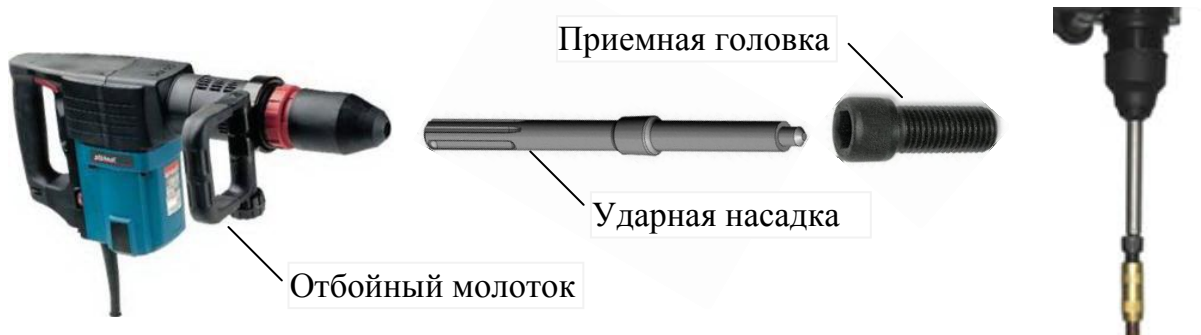
Рис. 9. Отбойный молоток для погружения заземляющего электрода
