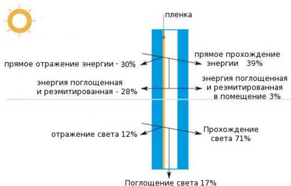
Рисунок 26 – Иллюстрация селективного отражения и пропускания излучения в видимом и инфракрасном диапазоне
