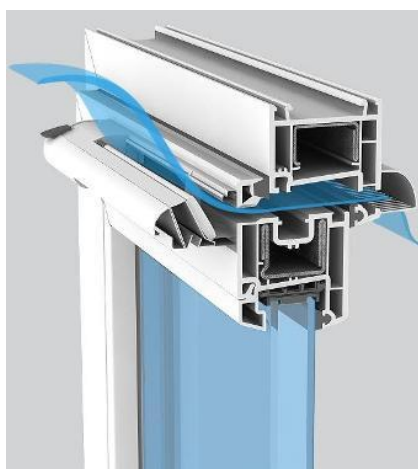
Рисунок 30 – Микропроветривание через встраиваемый инфильтрационный клапан
