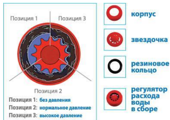
Рисунок 53 – Устройство и принцип действия регулятора расхода воды
